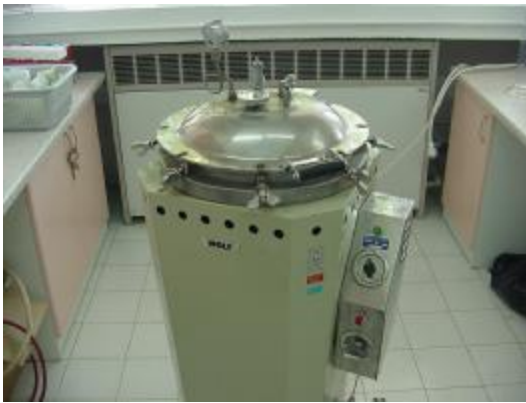
Şekil 3.4. Sterilizasyon işlemlerinin yapıldığı otoklav
