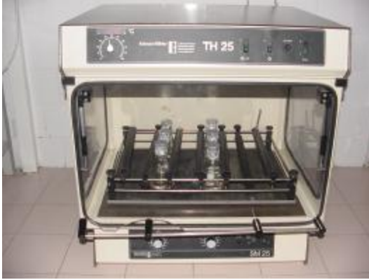
Şekil 3.6. Sıvı besiyerlerinde gelişen erlen mayerler içerisindeki miselin ısıtıcı karıştırıcıdaki görünümü
