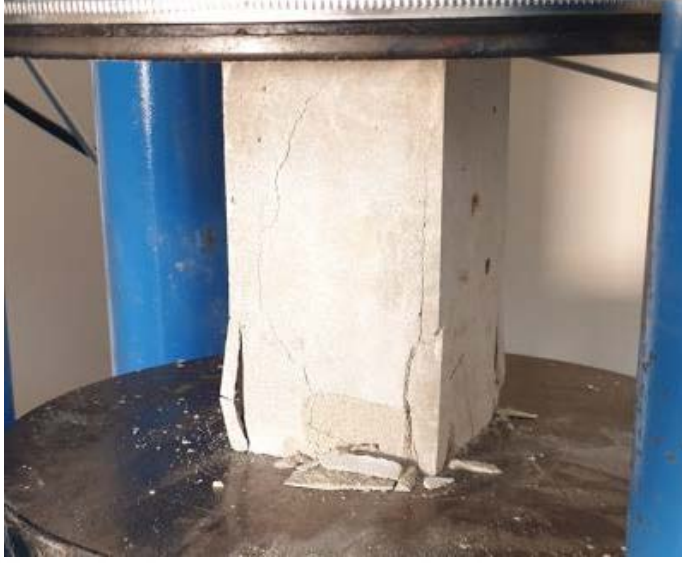
Şekil 4.3. Yapıştırıcı harç numunelerinin basınç testleri (Sabahoğlu 2022)
