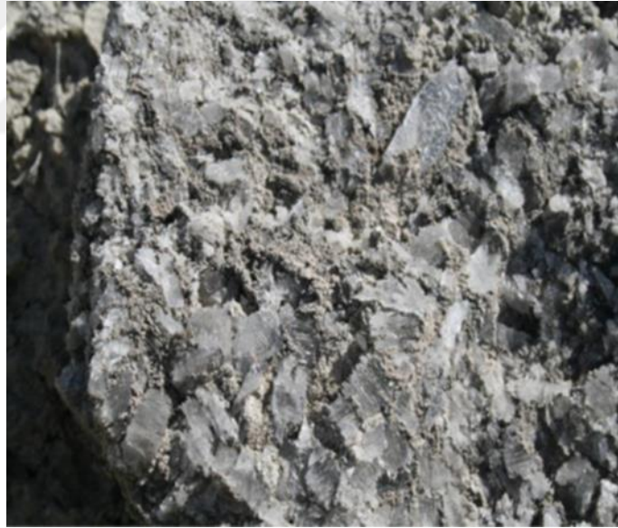
Şekil 1. 5. Kristal haldeki jipsin ( \text{Ca}_2\text{SO}_4 \cdot 2\text{H}_2\text{O} ) görünümü (Özdeniz vd., 2016, s. 58)
