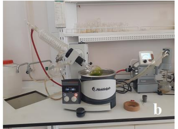
Şekil 3.16. (a) süzdürme işlemi (b) evaporasyon aşaması
