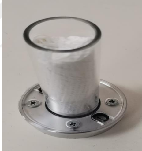
Şekil 3.7. Tüp içerisinde sabitlenmiş numune
