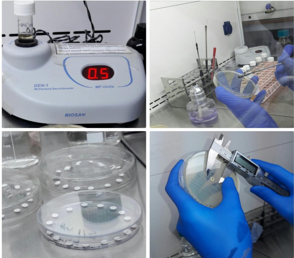
Şekil 3.2. Disk difüzyon metodunda; a) mikroorganizma yoğunluğunun belirlenmesi, b) hazırlanan mikroorganizma süspansiyonunun petriye ekimi, c) ekstrakt emdirilmiş disklerin yerleştirilmesi, d) inhibisyon zon çaplarının ölçümü aşamaları.
