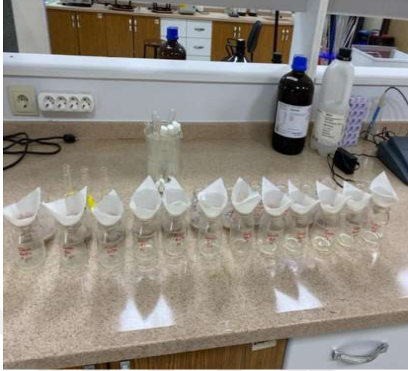
Resim 3.11 Homojenizatın filtre kağıdı yardımı ile süzülmesi.
