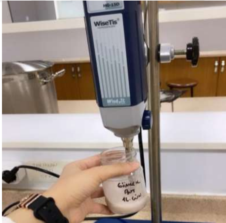
Resim 3.10 Et örneklerinin TCA çözeltisi ile homojenize edilmesi.
