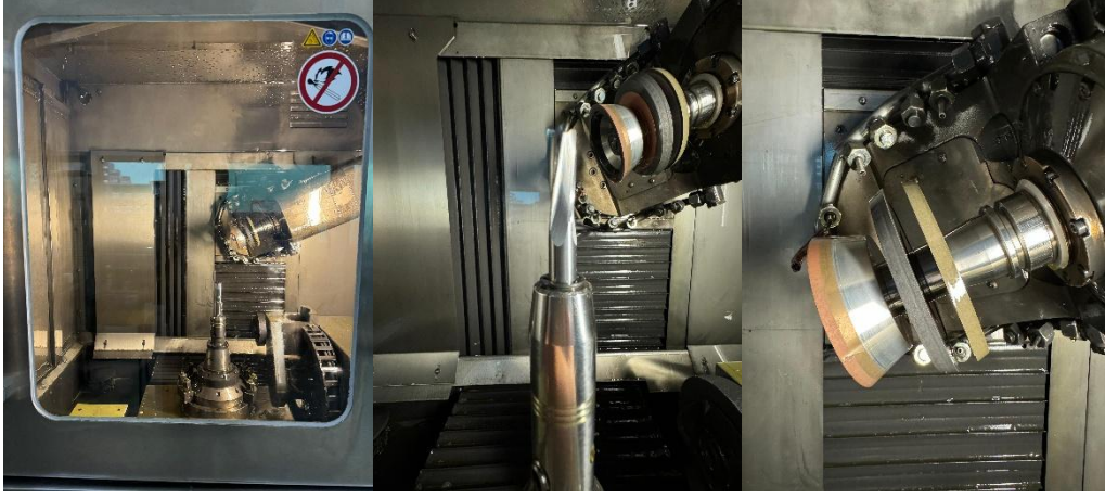
Şekil 5.14. Karbür çubuğun CNC taşlama tezgahında elmas taş seti ile işlenmesi
