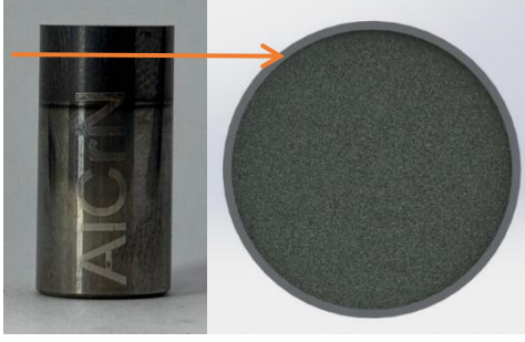
Şekil 6.5. AlCrN analizi için kaplanmış WC numune ve alınan kesit görüntüsü
