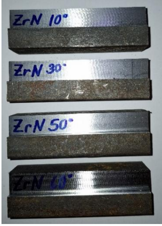
Şekil 6.19. ZrN kaplanmış parmak freze ile işlenmiş malzemelerin yüzey görselleri
