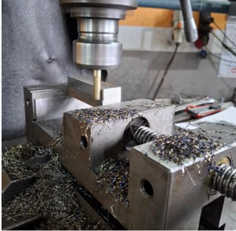
řekil 5.9. Parmak freze ve 1040 elięinin bağlanmış hali
