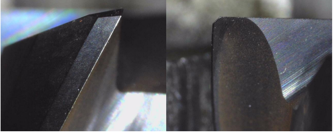
Şekil 6.56. AlTiN kaplanmış 30° parmak freze için aşınma görselleri
