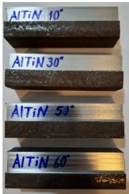
Şekil 6.50. AlTiN kaplanmış parmak freze ile işlenmiş malzemelerin yüzey görselleri
