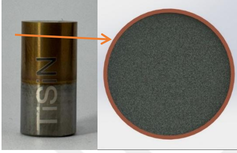
Şekil 6.9. TiSiN analizi için kaplanmış WC numune ve alınan kesit görüntüsü
