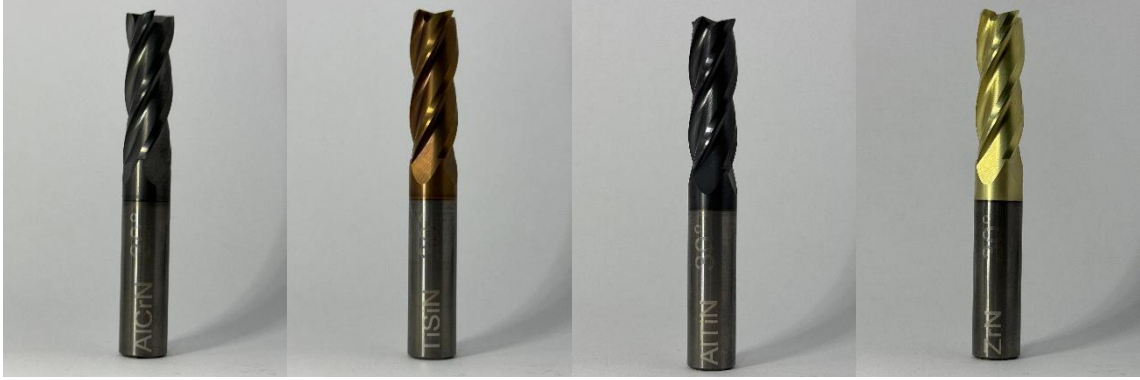
Şekil 5.18. Sırasıyla 30° AlCrN, TiSiN, AlTiN, ZrN kaplanmış numunelerin yanal görüntüleri
