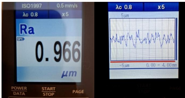
Şekil 6.18. Yüzey ölçüm cihazının ekran görüntüsü
