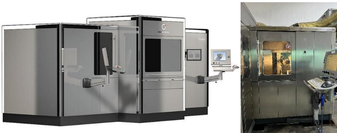
Şekil 5.6. Michael Deckel marka Flexus S22 model taşlama tezgahı (URL-14, 2025)
