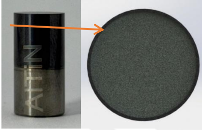
Şekil 6.13. AlTin analizi için kaplanmış WC numune ve alınan kesit görüntüsü
