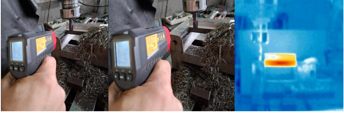
Şekil 5.10. İşlem sonunda çeliğin lazerli sıcaklık ölçümü ve termal görüntüsü
