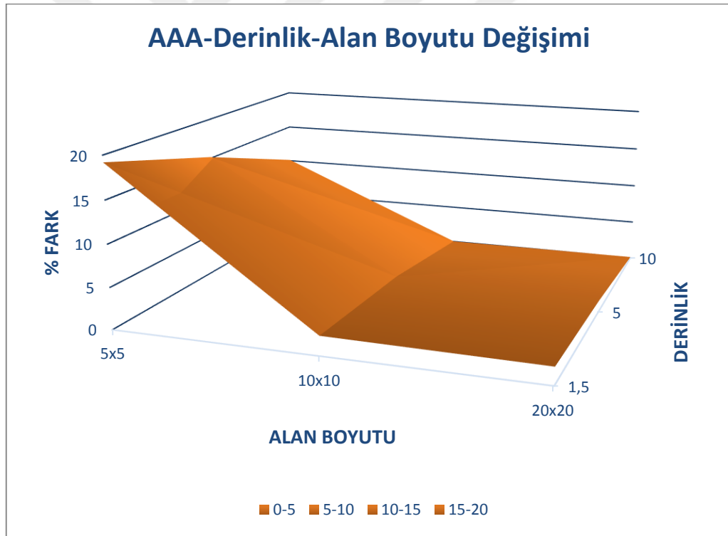
Şekil 4.10: AAA Hesap Algoritmasının Alan Boyutu ve Derinliğe Bağlı Değişimi
