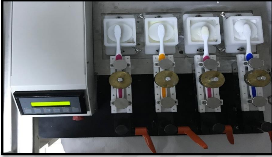
Şekil 2. Çalışmada Kullanılan Fırçalama Simülatörü
