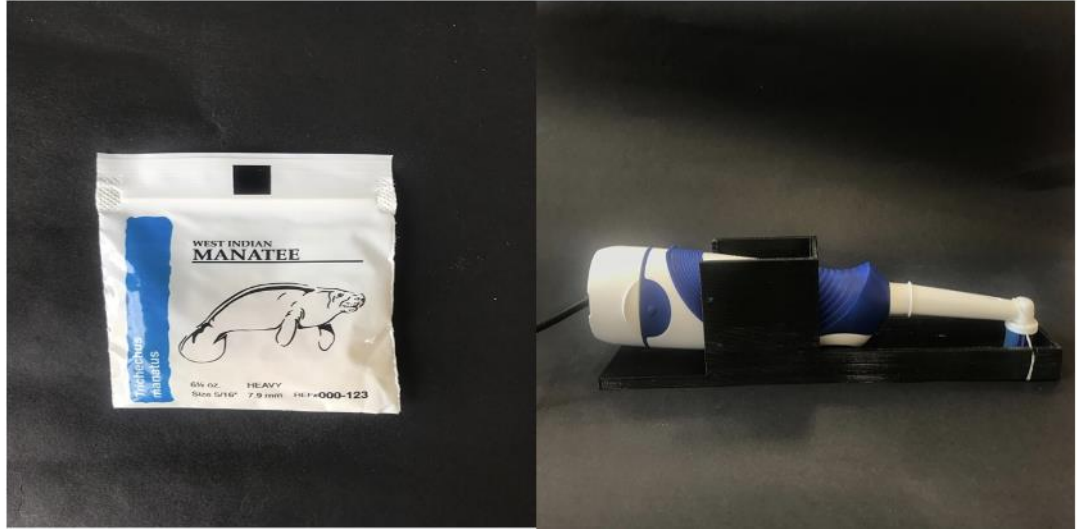
Şekil 3. 10. 2 N kuvveti taklit etmek için kullanılan ortodontik lastik, Fırçalama düzeneği
