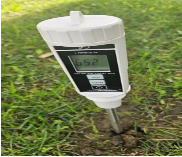
Şekil 4.26. Model kalibrasyonunda toprak nem ölçer cihazıyla nem ölçümü işleminin yapılması
