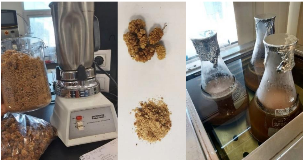
Şekil 3.7. Beyaz dut kurusuna uygulanan ön işlem ve ekstraksiyon
