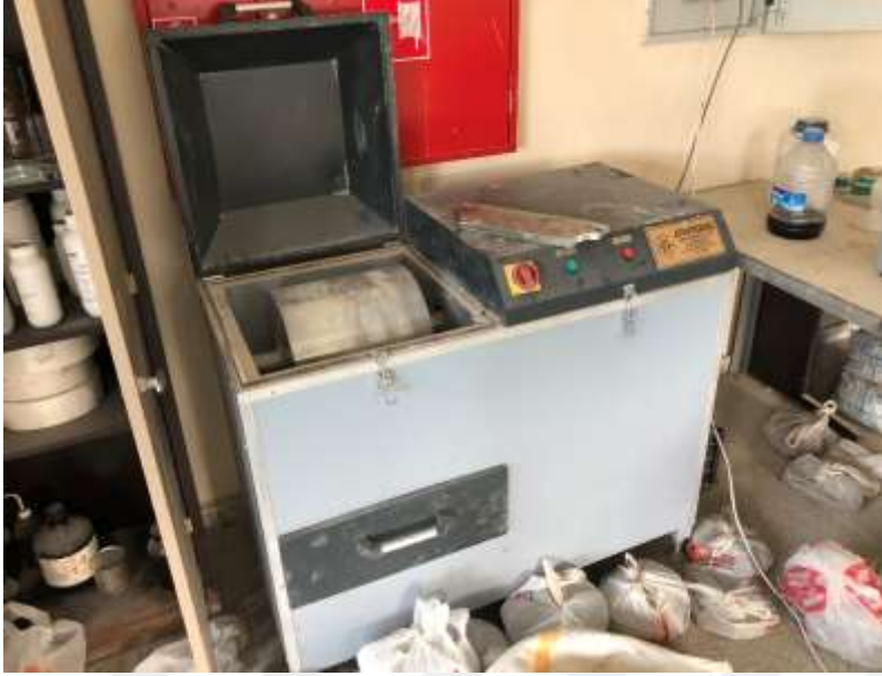
Şekil 9. Obsidyen, uçucu kül ve yüksek fırın cürufunun öğütüldüğü bilyeli değirmen
