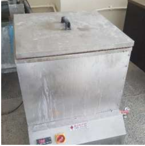
Şekil 12. Alkali silika reaksiyonu harç çubukların bekletildiği ısısı ayarlanabilir tank
