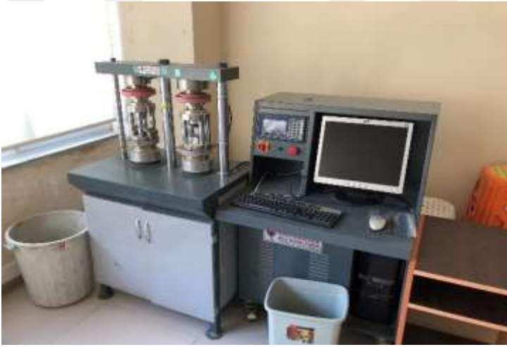
Şekil 15. 2, 7 ve 28 günlük eğilme ve basınç deneylerinin yapıldığı cihaz
