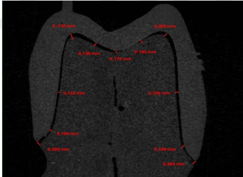
Şekil 4.20. Grup MS ile Üretilen Kuronun Mikro-BT ile Sagital Kesiti
