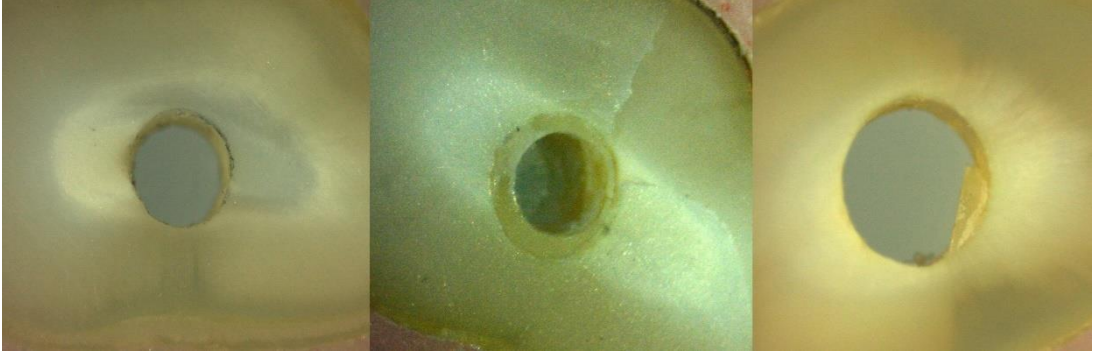
Şekil 28. Sırasıyla adeziv, koheziv ve karışık kopma tipinin stereomikroskop görüntüsü
