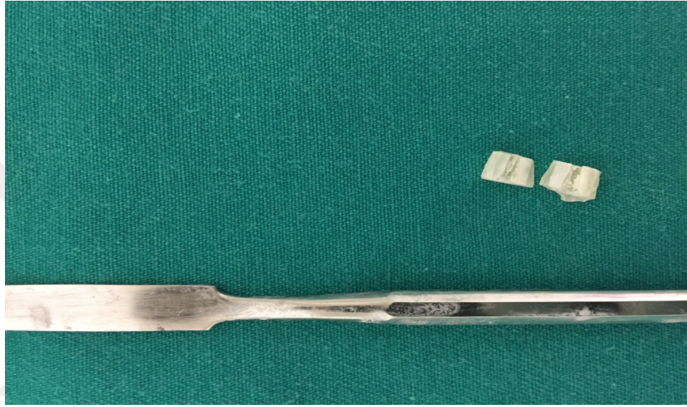
Fotograf 3.3. Örneklerin siman spatülü yardımı ile vertikal olarak 2 parçaya ayrılması.
