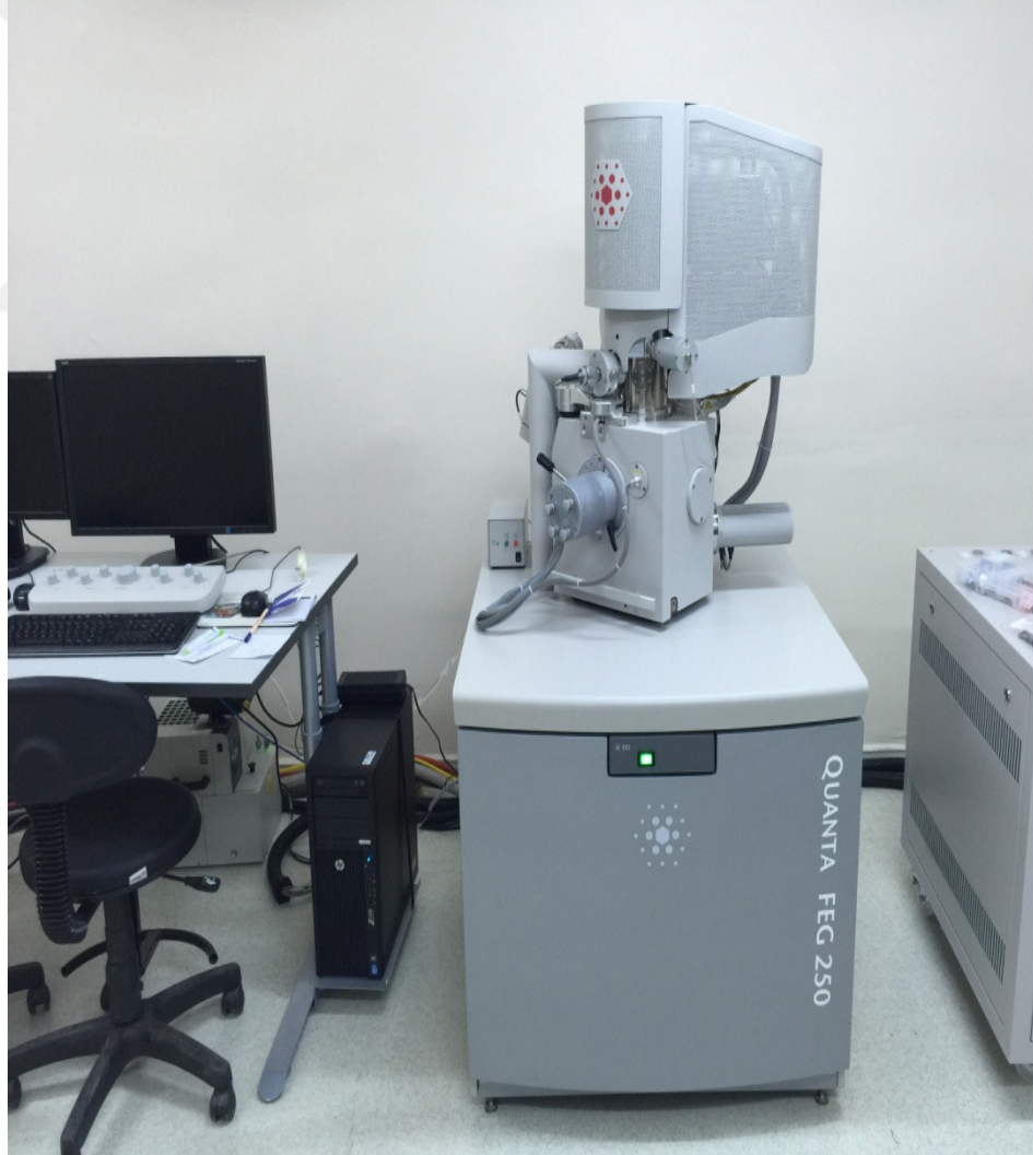
Fotograf 3.5. Görüntüleme ve elementel analizlerin yapıldığı Quanta FEG 250 cihazı.
