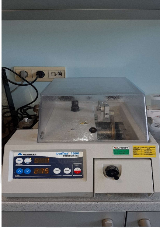
Resim 18: IsoMet kesit cihazı ve oluşturduğu dentin diskleri
