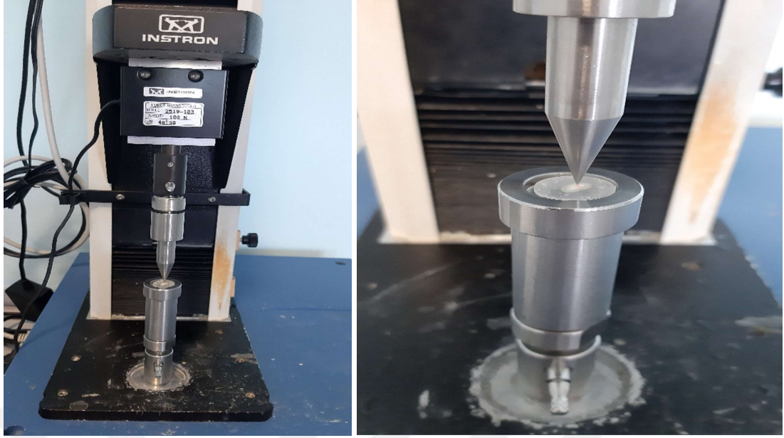
Resim 20: Dentin disklerine Instron cihazı ile kuvvet uygulanması
