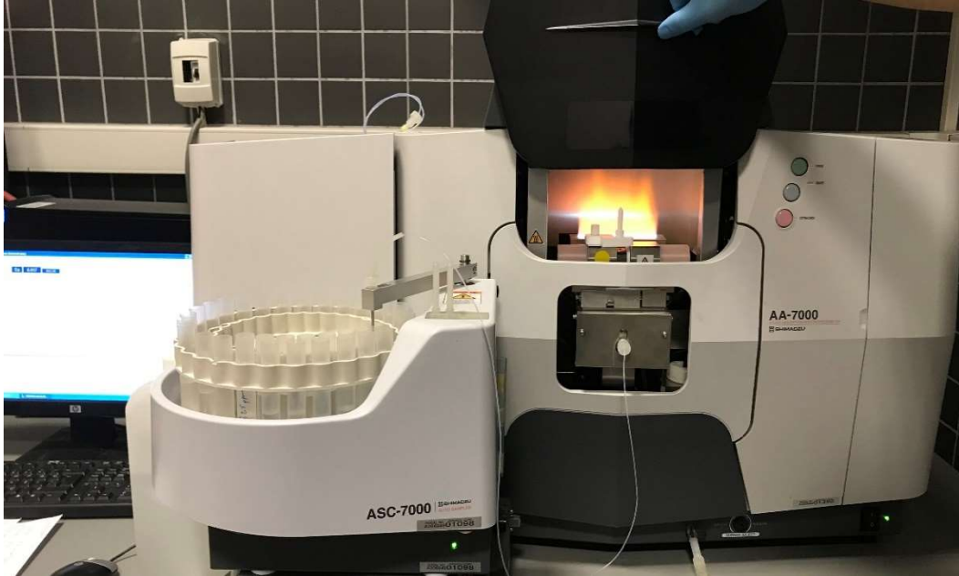
Resim 15: Örneklerden kalsiyum tayinini sağlayan yanma olayı
