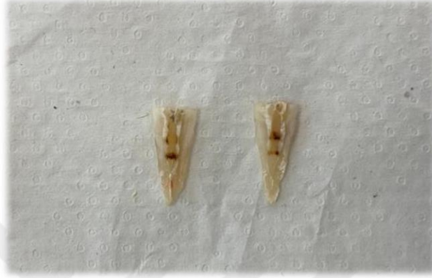
Şekil 3.8. SEM incelemesi için örneklerin hazırlanması
