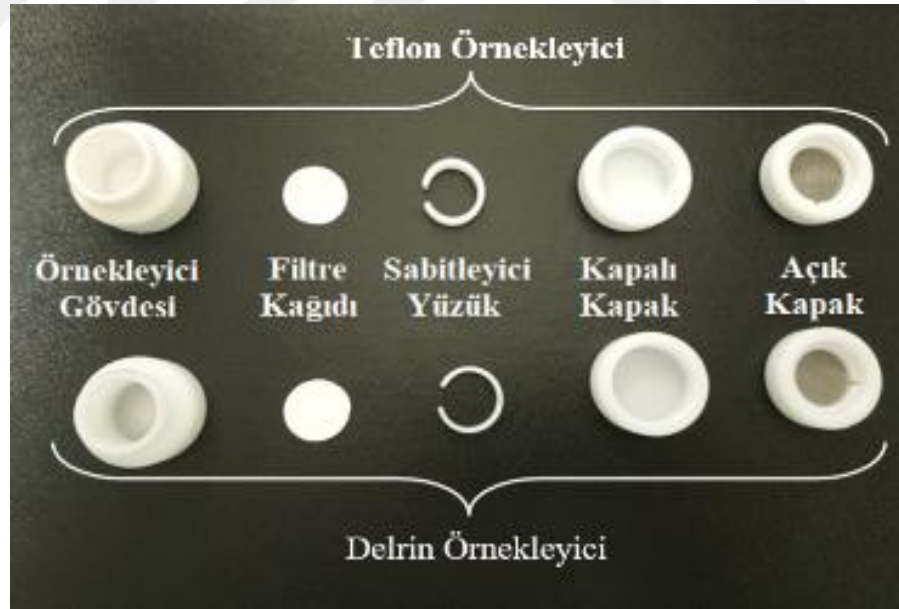
Şekil 5.6. İnorganik pasif örnekleyiciler (teflon ve delrin) ve kısımları
