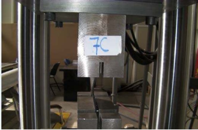
Resim 5.7. Burkulma testinden sonra test numunesinin görüntüsü
