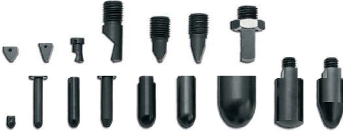
Resim 5.2. Ağırlık düşürme test cihazı ile kullanılabilecek değişik darbe uçları
