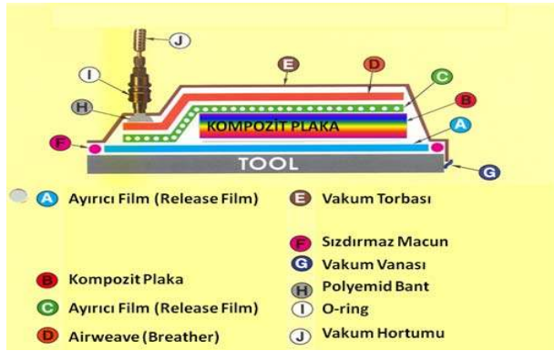
Şekil 4.4. Otoklav kalıplama prosesi
