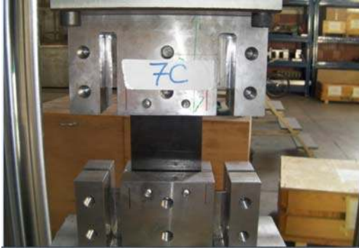
Resim 5.6. Burkulma testi için test numunesinin bağlanması
