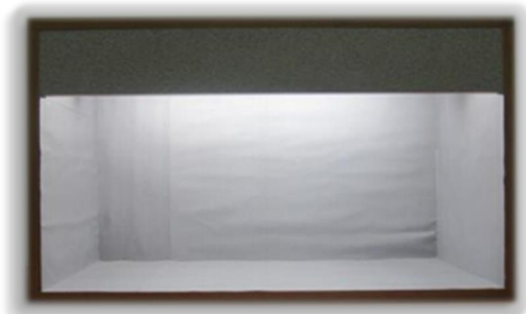
Resim 41. Ölçümlerin yapıldığı nötral gri fonla kaplı renk ölçüm kutusu
