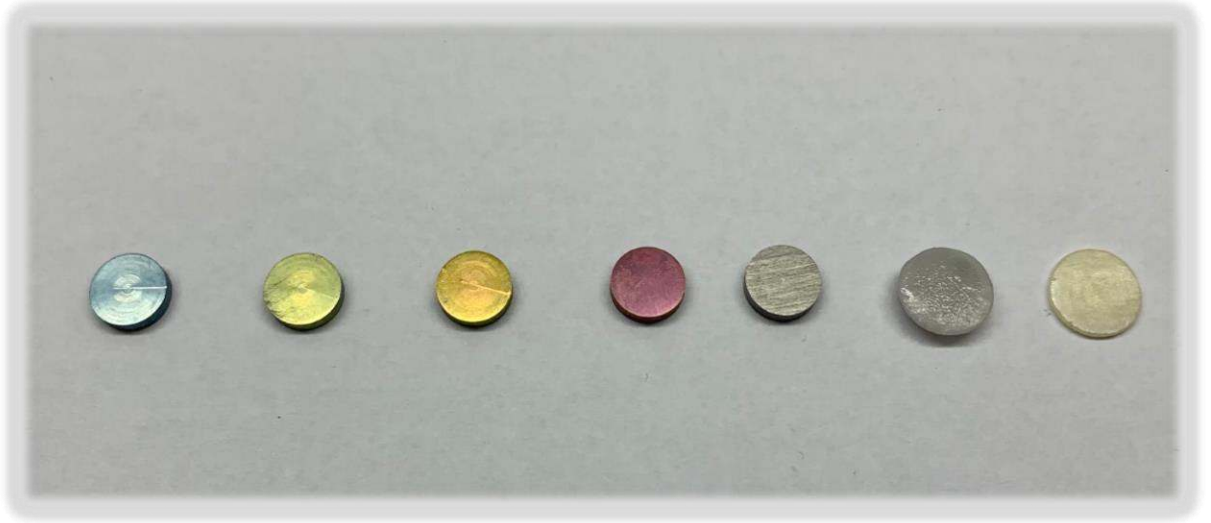
Resim 30. Kullanılan dayanak materyalleri soldan sağı sırasıyla; 37 V, 51 V, 59 V ve 67 V anodize titanyumlar, Titanyum, Hibrit dayanak konsepti (Titanyum+Lityum Disilikat), zirkonya
