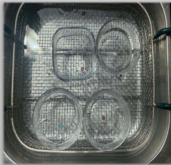
Resim 39. Anodize titanyum disklerin ultrasonik cihazda yüzeyindeki eklentilerin eliminasyonu
