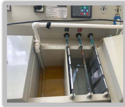
Resim 33. Örneklerin saf su ile durulanması daldırılması
