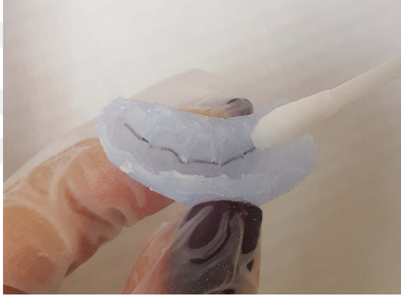
Şekil 5-Kompozit pedlerin saf aseton ile debris artıklarından temizlenmesi
