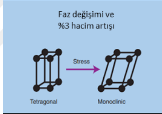
Şekil 2.2. Tetragonal-monoklinik faz dönüşümü (25)
