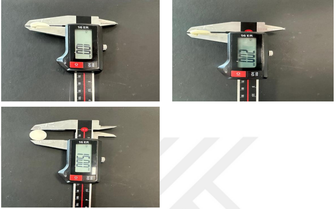
Şekil 3.5. Örnek boyutlarının dijital kumpasla ölçülmesi
