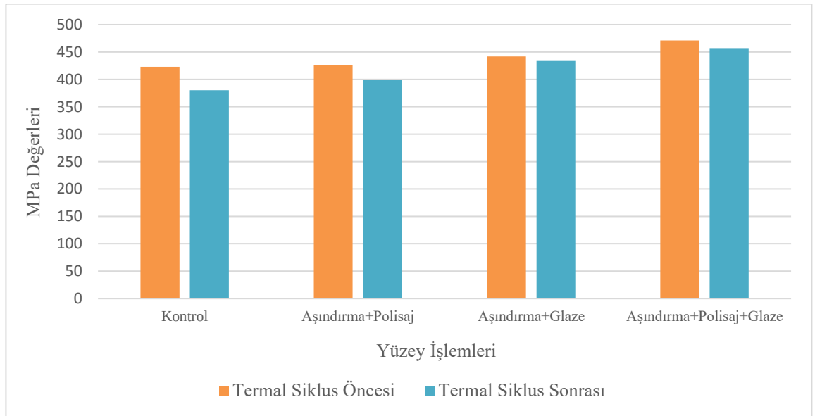
Şekil 4.10. Termal siklus işlemi ve yüzey işlemi gruplarının iki eksenli bükülme dayanımı (MPa) ölçüm değerleri
