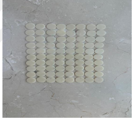
Şekil 3.9. Termal siklus işlemi uygulanan ve uygulanmayan örnek grupları
