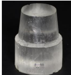
Şekil 3.5. 1mm kalınlığında 135° shoulder basamak die model çizimi, metal master die model, epoksi rezin die model
