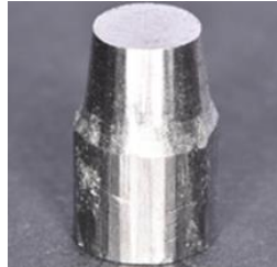
Şekil 3.5. 1mm kalınlığında 135° shoulder basamak die model çizimi, metal master die model, epoksi rezin die model
