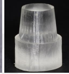
Şekil 3.3. 1mm kalınlığında 90° shoulder basamak die model çizimi, metal master die model, epoksi rezin die model
