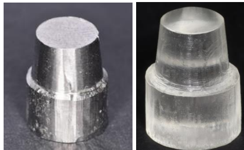
Şekil 3.9. 1mm kalınlığında deep chamfer basamak die model çizimi, metal master die model, epoksi resin die model
