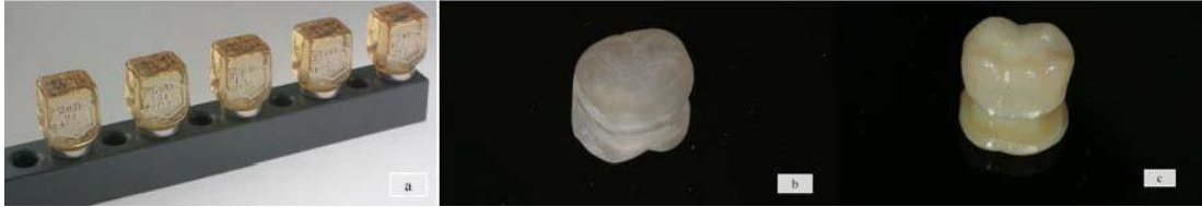
Şekil 2.1. a) Vita Suprinity freze edilmemiş blok b) frezeleme sonrası monolitik kron c) sinterleme sonrası kristalizasyonu tamamlanmış monolitik kron
