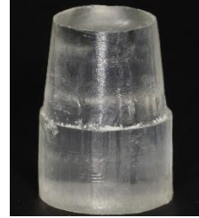
Şekil 3.4. 0,5mm kalınlığında 90° shoulder basamak die model çizimi, metal master die model, epoksi rezin die model
