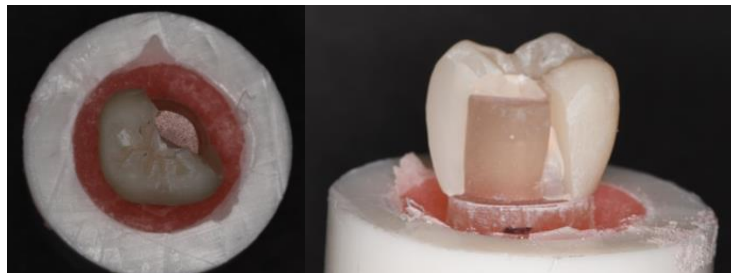
Şekil 4.4. 1mm kalınlığında 90° shoulder basamak tipinde ZLS krona görülen Tip II kırılma
