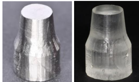
Şekil 3.8. 0,5mm kalınlığında chamfer basamak die model çizimi, metal master die model, epoksi resin die model
