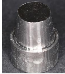
Şekil 3.4. 0,5mm kalınlığında 90° shoulder basamak die model çizimi, metal master die model, epoksi rezin die model
