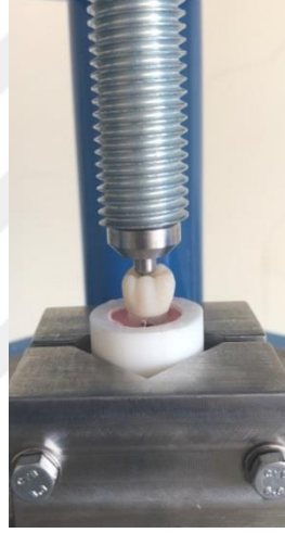
Şekil 3.35. Test cihazındaki örneğin kırılma anı öncesi
