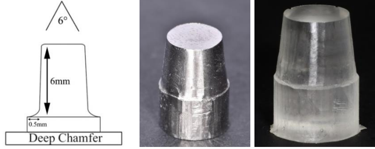
Şekil 3.10. 0,5mm kalınlığında deep chamfer basamak die model çizimi, metal master die model, epoksi rezin die model
