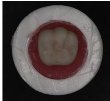
Şekil 4.3. 0,5 mm kalınlığında 135° shoulder basamak tipinde ZLS krona görülen Tip I kırılma
