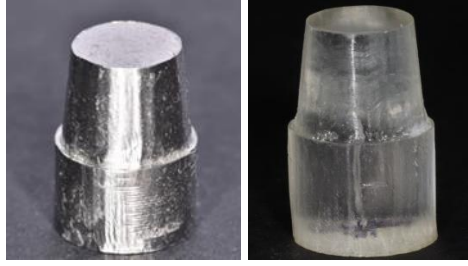
Şekil 3.6. 0,5mm kalınlığında 135° shoulder basamak die model çizimi, metal master die model, epoksi resin die model
