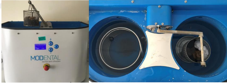
Şekil 3.31. Örneklerin termal siklus işlemiyle yaşlandırılması
