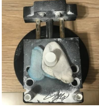
Şekil 3.12. Die modelin yansıtıcı spray tozuyla kaplanması ve ağız dışı tarayıcıya yerleştirilmesi
