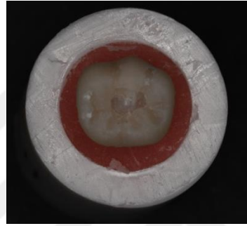
Şekil 4.2. 1mm kalınlığında 135° shoulder basamak tipinde ZLS krona görülen Tip I kırılma
