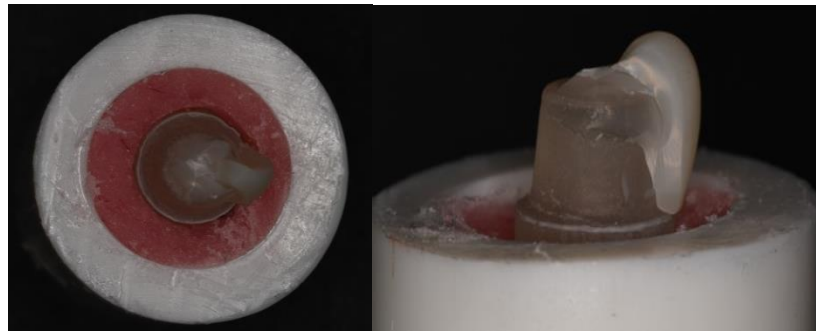
Şekil 4.8. 1 mm kalınlığında deep chamfer basamak tipinde ZLS kronda görülen Tip IV kırılma
