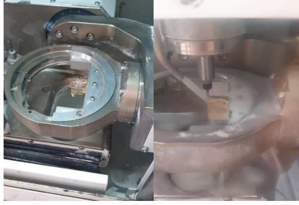
Şekil 3.21. Bloğun freze ünitesine yerleştirilmesi ve freze edilmesi
