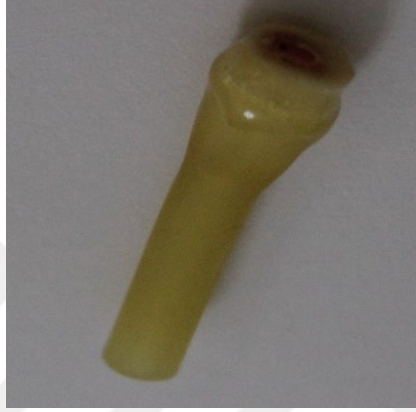
Fotoğraf 3. 11. Örneklerin plastik borulara yerleştirilip sabitlenmesi
