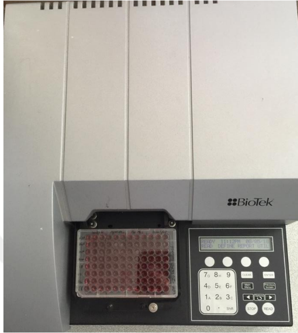
Şekil 3-14: Spektrofotometre Cihazı (Biotek ELX800UV)
