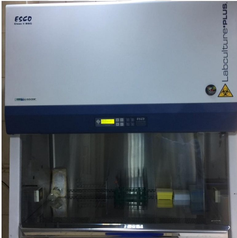
Şekil 3-6: Laminar Air Flow Hava Akış Kabini (ESCO AC2-4E8)
