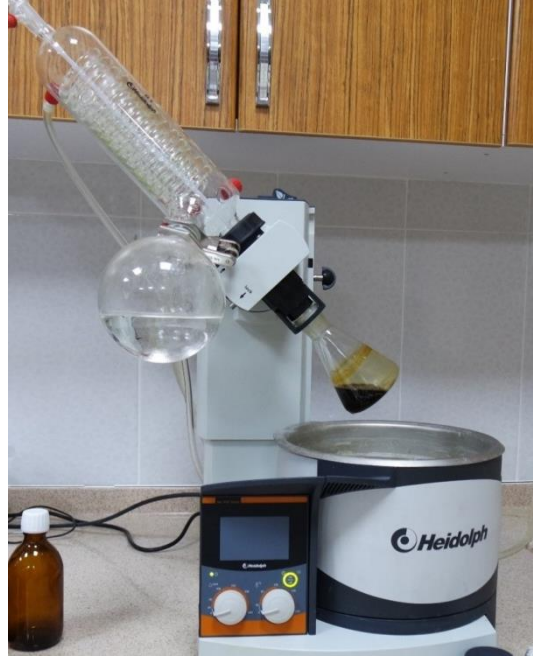
Resim 3.2 Rotary evaporatörde alkolün uçurulması.
