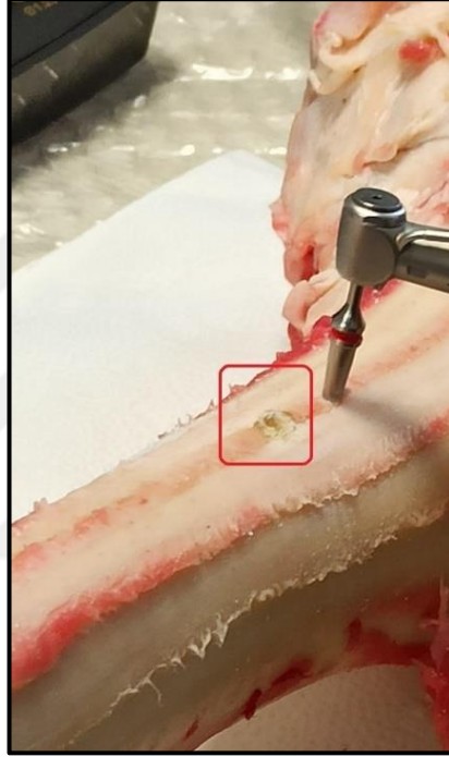
Şekil 4.1. Deneylerde çıkan kemik tozu görünümü
