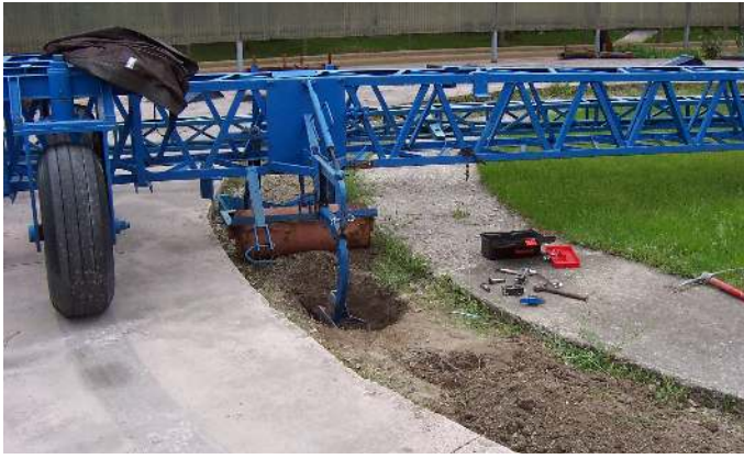
Resim 7.14. Pulluk uç demirinin platforma bağlanması
