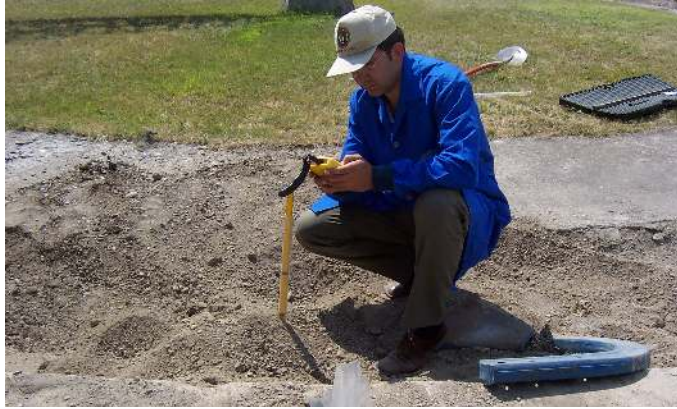
Resim 7.18 Mobil nem ölçer cihazı ile nem ölçümü yapılırken
