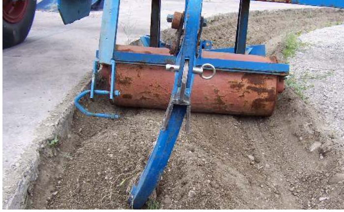
Resim 7.11. Pulluk uç demirinin platforma bağlanması
