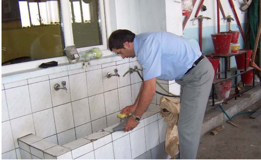
Resim 7.20. Aşındırma deney standından sökülen uç demiri temizlenirken
