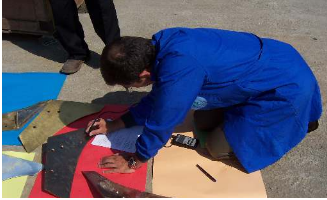
Resim 7.24. Temizlenmiş uç demirlerinin kaplama kalınlıkları ölçölürken
