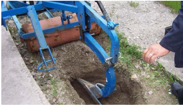
Resim 7.12. Pulluk uç demirinin platforma bağlanması
