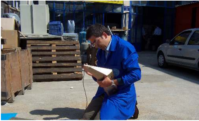
Resim 7.23. Temizlenmiř uç demirlerinin kaplama kalınlıkları ölçülürken
