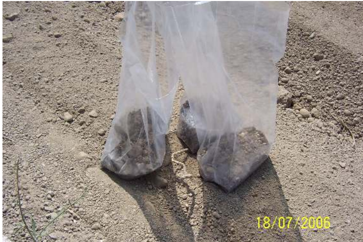
Resim 7.16. Nem miktarı ölçülmek üzere hazırlanmış numune
