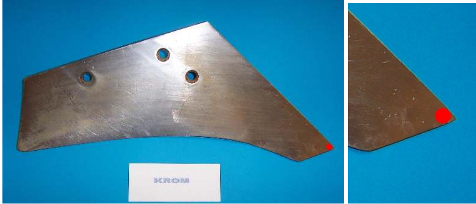
Resim 7.25. Temizlenmiş uç demirlerinin kaplama kalınlıklarının ölçüldüğü referans nokta
