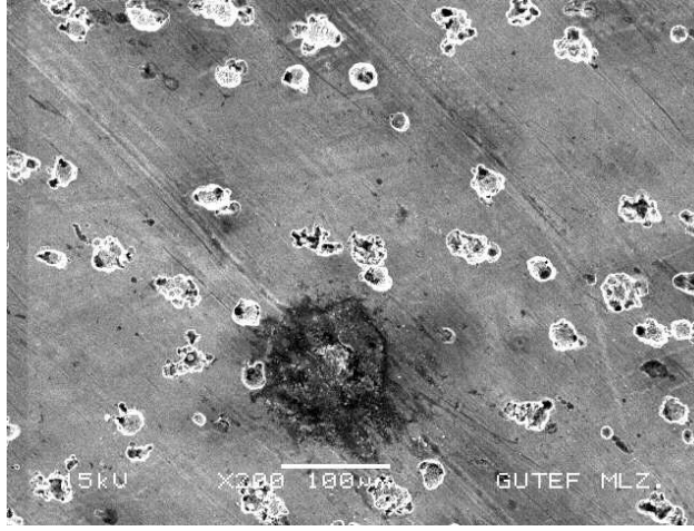
Resim 8.7. Titanyum nitrür kaplanarak aşındırılmış deney numunesi yüzeyi SEM görüntüsü
