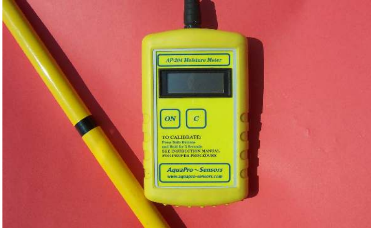
Resim 7.2. Seyyar nem ölçme cihazı
