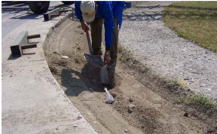
Resim 7.19. Nem tayini için toprak numunesi alınırken
