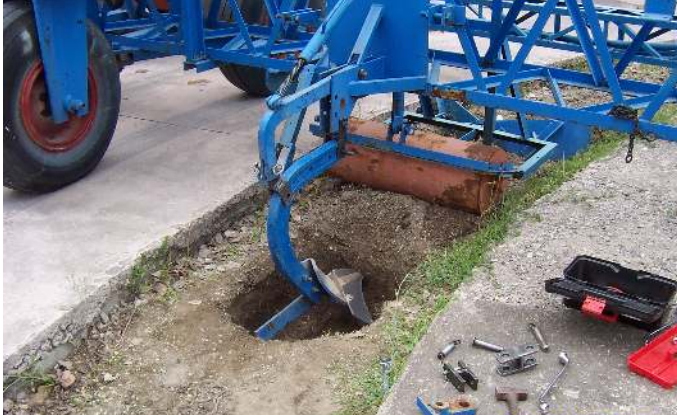
Resim 7.13. Pulluk uç demirinin platforma bağlanması
