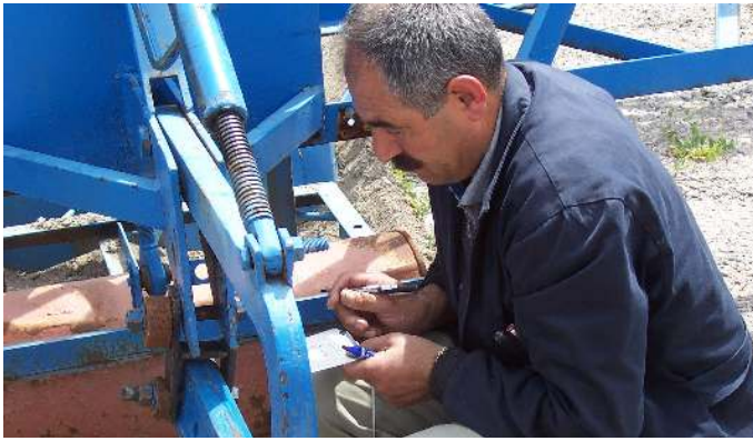
Resim 7.15. Pulluk uç demirinin platforma bağlanması
