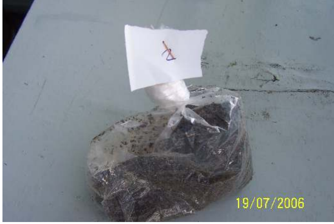
Resim 7.17. Nem miktarı ölçülmek üzere hazırlanmış numune
