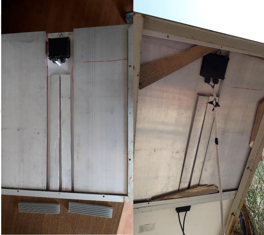
Resim 3.3 Panel Altına Yerleştirilen Alüminyum Malzeme.
