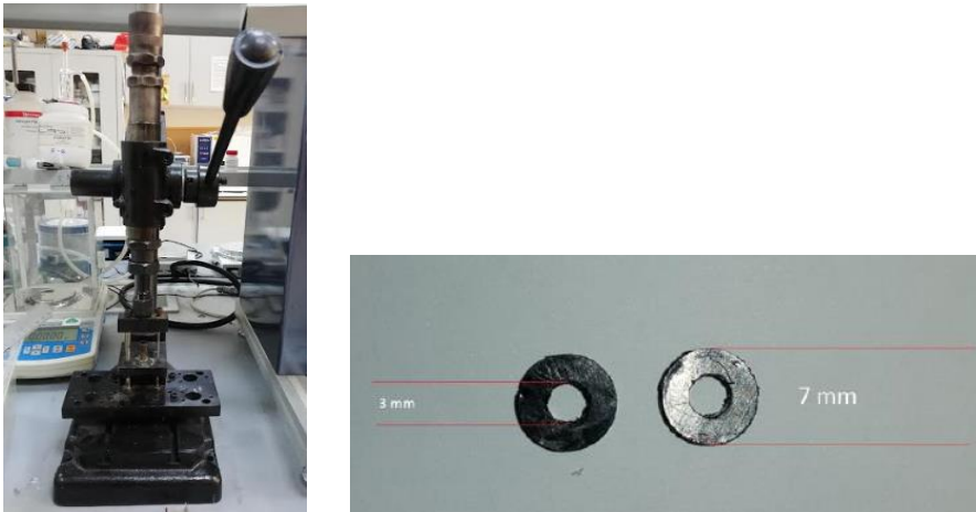
Şekil 3.9. VNA testinin analizleri için kullanılan hazırlama cihazı ve hazırlanan malzemelere ait fotoğraflar
