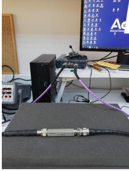
Şekil 3.10. Elektriksel geçirgenlik değeri analiz ölçümünde kullanılan VNA test düzeneği
