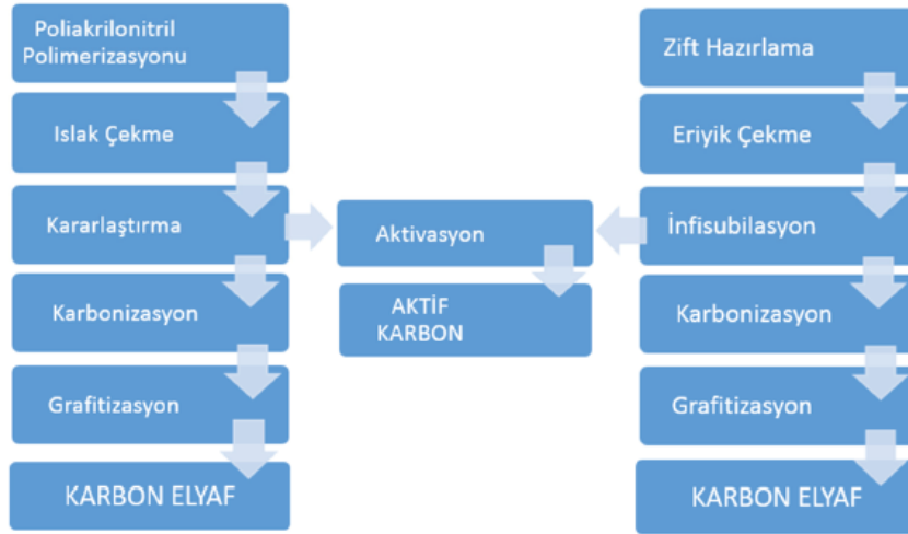
Şekil 2.8. Zift ve PAN temelli karbon elyaf üretimine ait proses akış şeması [18]
