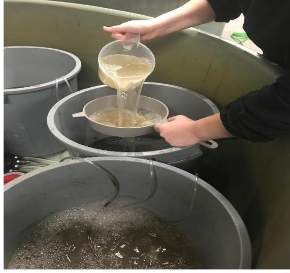
Şekil 3-3: Biyoyumakların süzölme işlemi.
