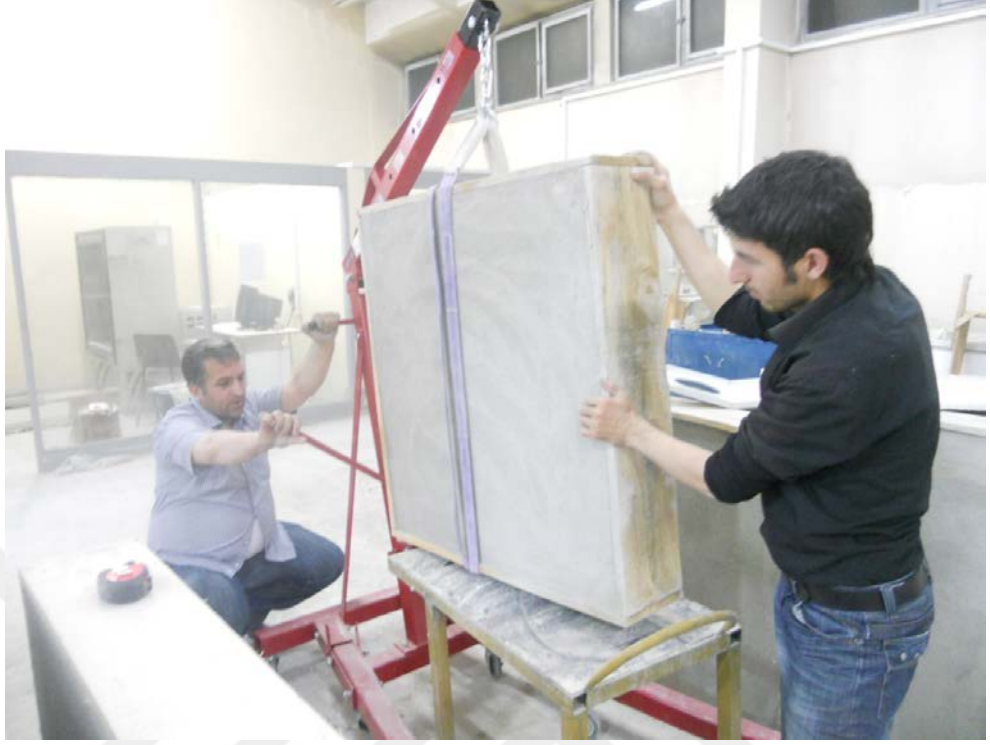
Şekil 3.7. Duvar örneğinin kaldırma düzeneği ile sehpaye alınması
