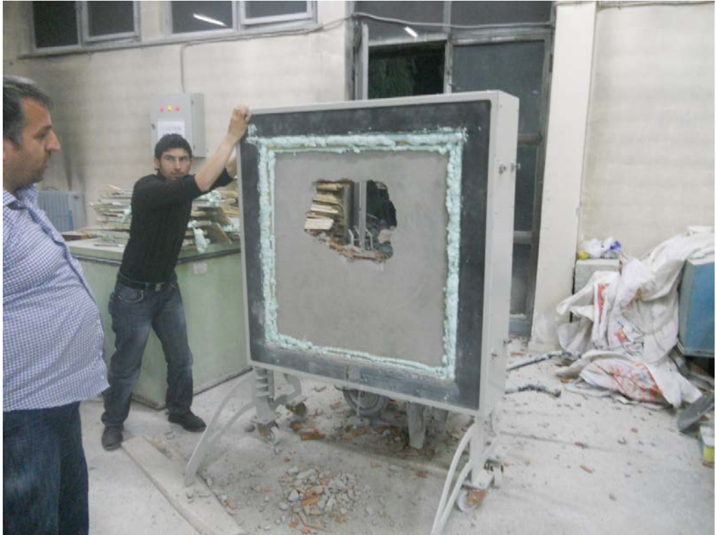
Şekil 3.10. Ölçümü tamamlanan duvar örneğinin kırılması
