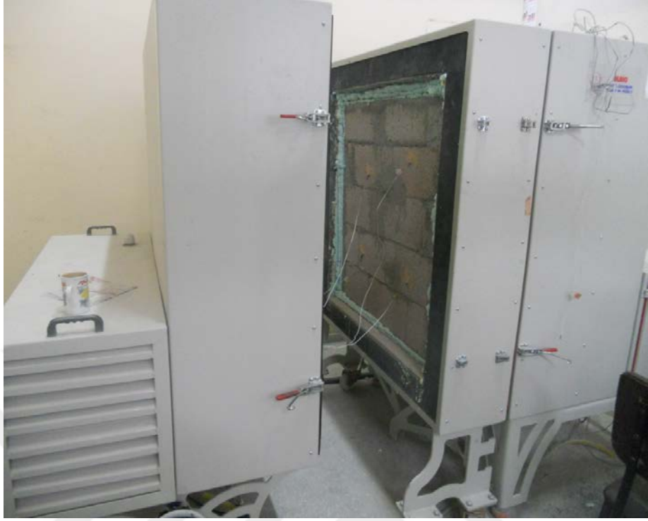
Şekil 3.9. Duvar örneğinin ısı iletkenliğinin ölçümü
