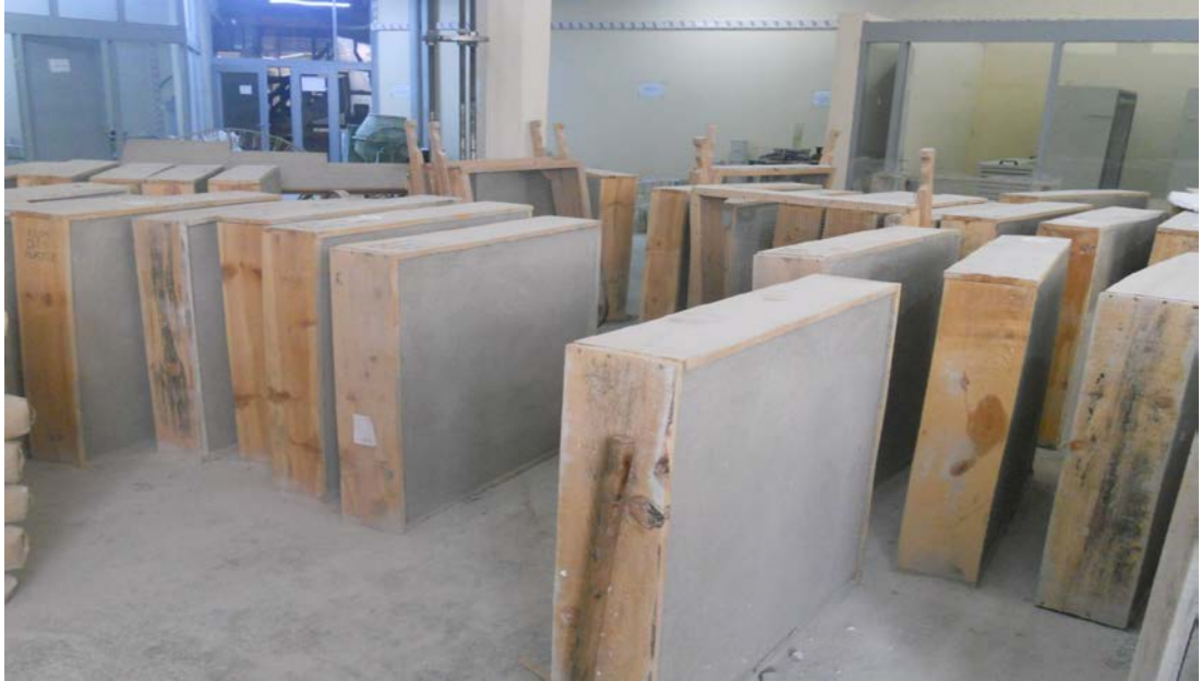
Şekil 3.6. Sıvaları tamamlanmış duvar örneklerinin görünümü
