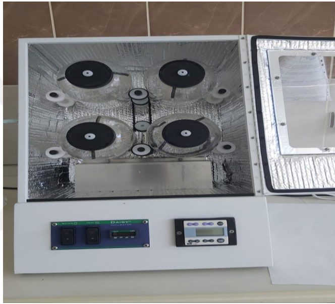
Şekil 3.11. Daisy inkübatör, Ankom Model D220, USA
