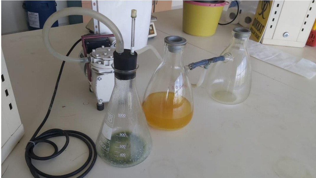
Şekil 3.8. Selüloz süzme seti cihazı-vakum pompalı (Şimşek Labortek)
