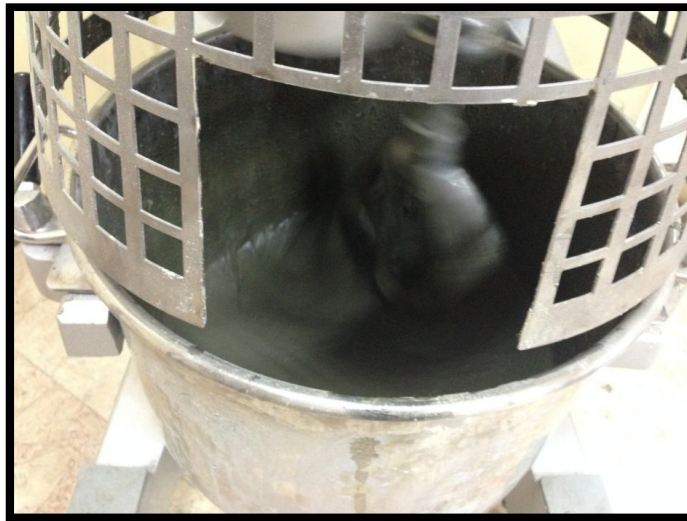
Şekil 4.19. SİFCON için hazırlanmış malzeme karışımı
