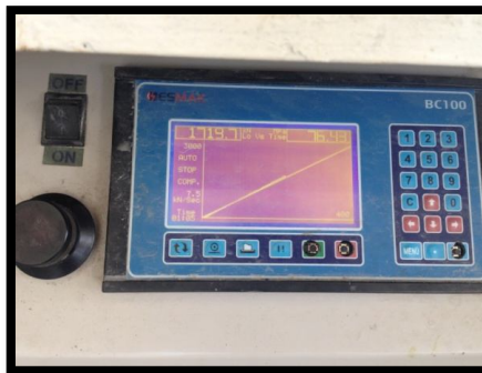
Şekil 4.33. Beton basınç dayanımı ölçüm görüntüsü
