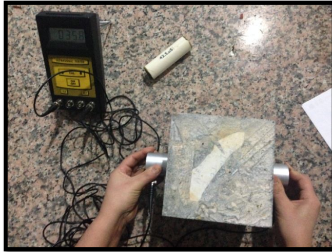
Şekil 4.42. Ultrases geçiş hızı deneyi problarla deneyin uygulanması
