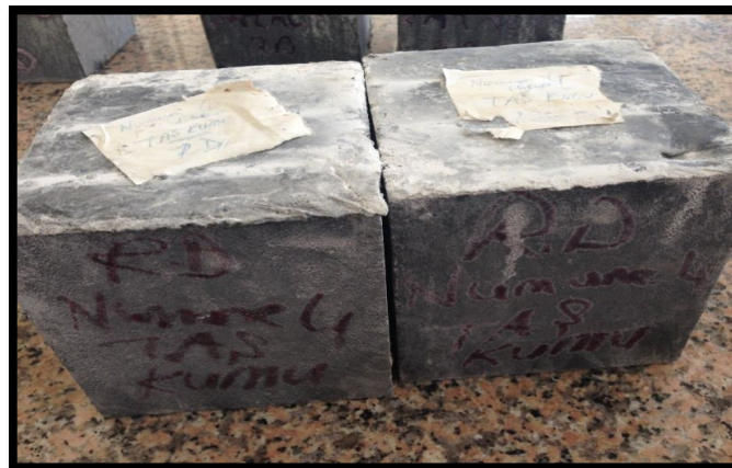
Şekil 5.7. Beton basınç dayanımı küp numuneleri
