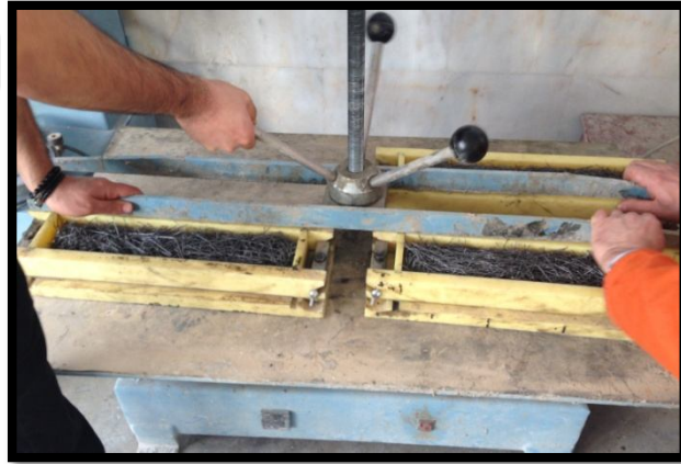
Şekil 4.23. Lifler yerleştirilmiş kalıpların sarsma makinesine yerleştirilmesi
