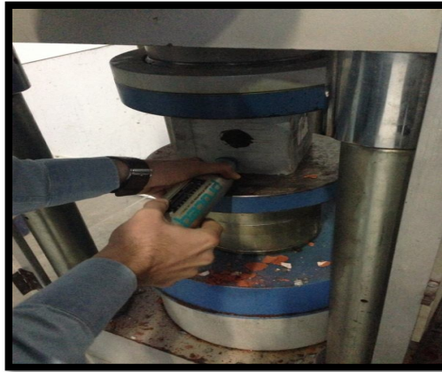
Şekil 4.44. Schmidt çekici numuneye uygulanması
