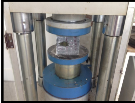
Şekil 4.32. Beton basınç dayanımı deneyi
