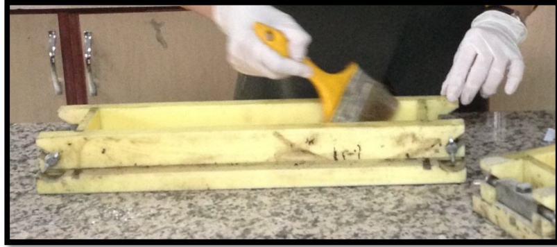
Şekil 4.20. Liflerin yerleştirileceği kalıbın yağlanması
