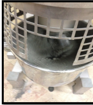
Şekil 4.18. SİFCON için hazırlanmış çimento ve silis dumanı karışımı
