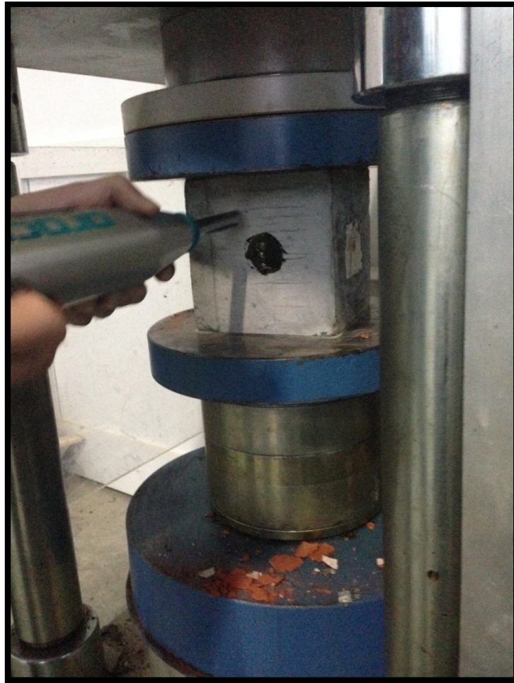
Şekil 5.16. Schmidt çekici deneyi numuneye uygulanması
