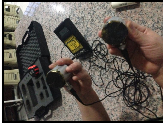
Şekil 4.41. Ultrases geçiş hızı deneyi probalara gres yağı sürülmesi
