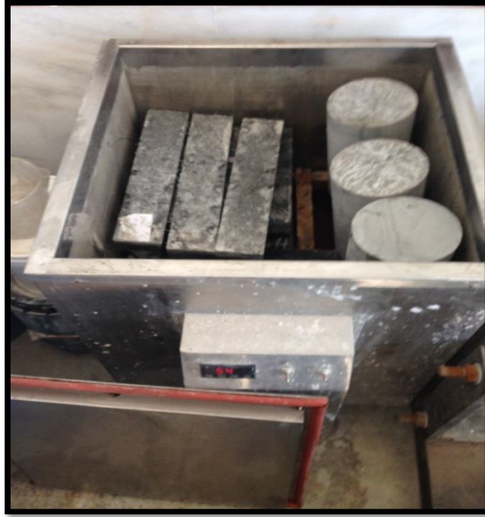
Şekil 4.28. SİFCON numunelerinin buhar kürüne yerleştirilmesi
