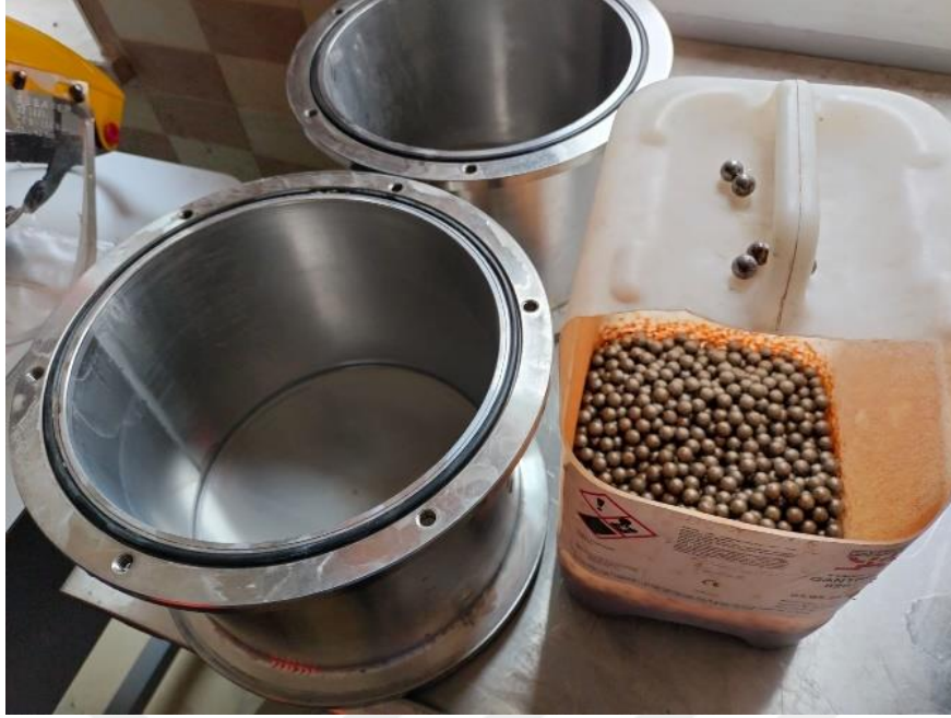
Şekil 4.6: Micro Deval deneyinde kullanılan tambur ve bilyalar
