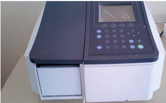
Resim 2.3. UV-GB spektrofotometresi (UV-1800 UV-VIS spectrophotometer) (Orijinal)
