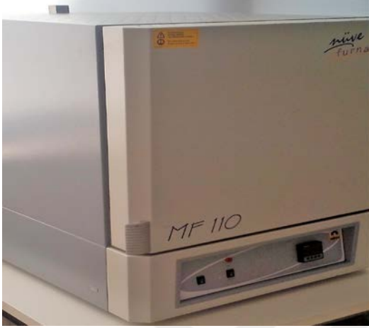
Resim 2.2. Kül fırını (Nüve MF 110) (Orijinal)
