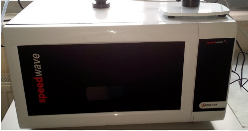
Resim 2.4. Mikrodalga parçalama sistemi (Microwave system Berghof Speedwave 2) (Orijinal)
