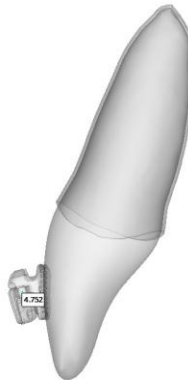
Şekil 4.108. Carriere SLX 3D-5° İnklinasyon-TMA Tel Kullanımı Moment Değeri
