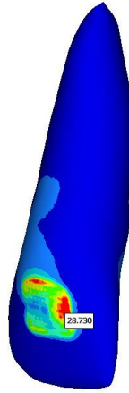
Şekil 4.121. Carriere SLX 3D-10° İnklinasyon-SS Tel Von Mises Stres Dağılımı
