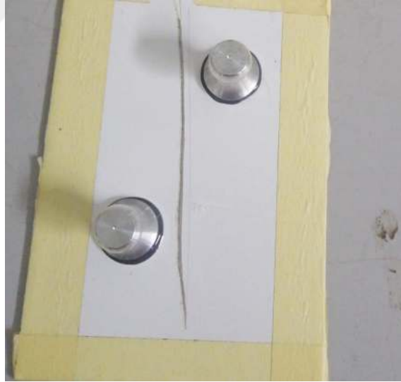
Şekil 5.25 Ral 9003 Pull Off Analizi
