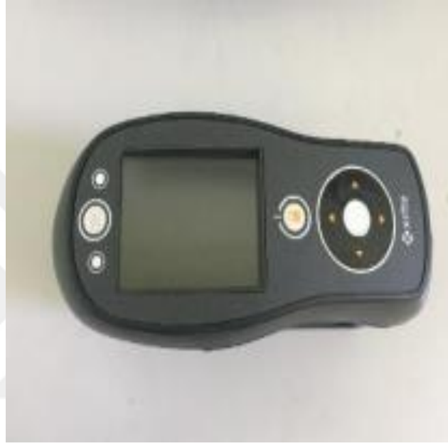
Şekil 4.12. X-Rite Ci64 renk spektrometresi
