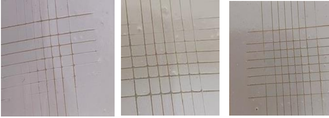
Şekil 5.19. Ral 9003 (a) % 0.5 Kaolin (b) % 0.5 Mmt (c) % 0.5 Sepiyolit katkı maddeleri eklenmiş boyalarla boyanmış plakların çapraz kesme deneyi görseli
