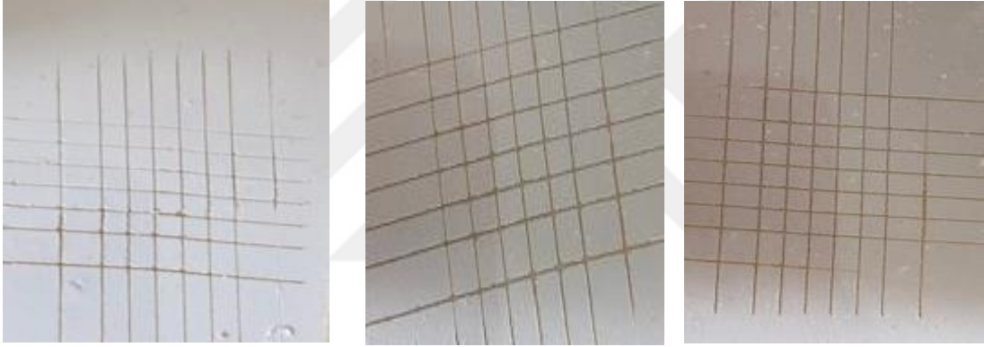
Şekil 5.20. Ral 9003 (a) % 1 Kaolin (b) % 1 Mmt (c) % 1 Sepiyolit katkı maddeleri eklenmiş boyalarla boyanmış plakların çapraz kesme deneyi görseli
