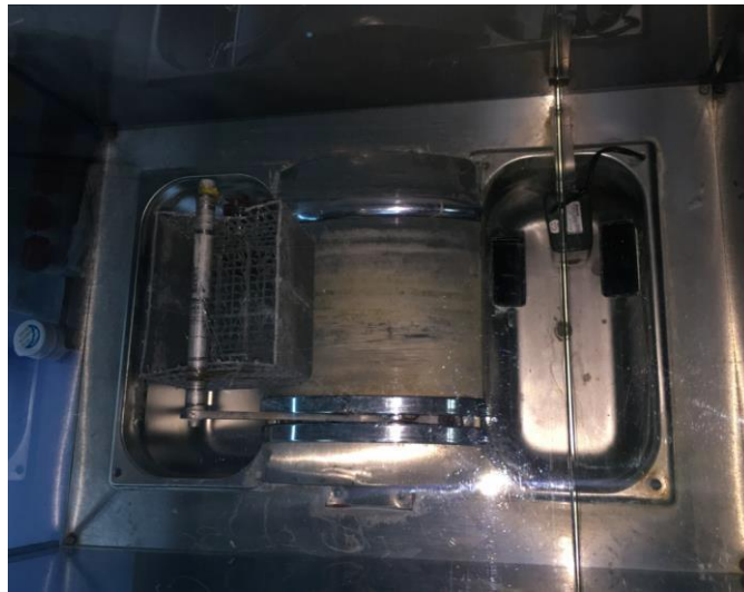
Şekil 3-14: Çalışmada kullanılan termal siklus cihazının soğuk ve sıcak su haznesi
