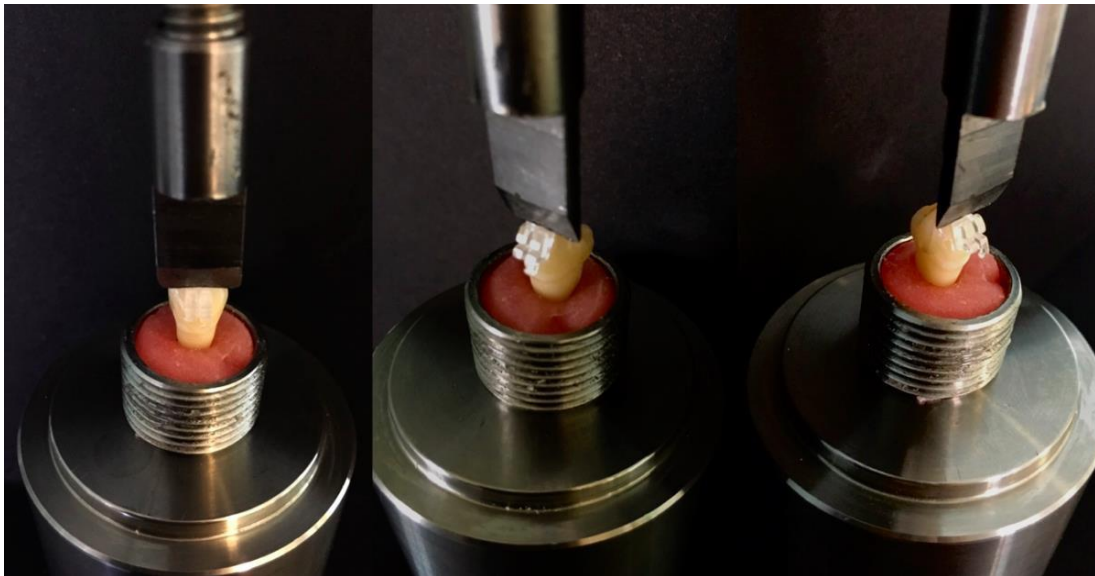
Şekil 3-31: Evrensel test cihazının yükleme ucunun braket-diş arasına yerleştirilmesi
