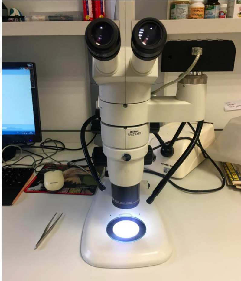
Şekil 3-32: Çalışmada kullanılan stereomikroskop cihazı
