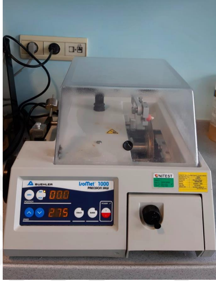
Şekil 3-52: Dişlerin kuronlarını ayırmak için kullanılan hassas kesme cihazı
