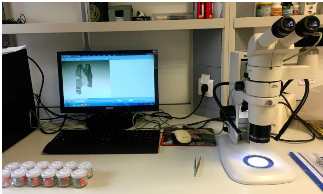
Şekil 3-35: Çalışmada kullanılan stereomikroskop cihazı ile braket kaidelerinin incelenmesi
