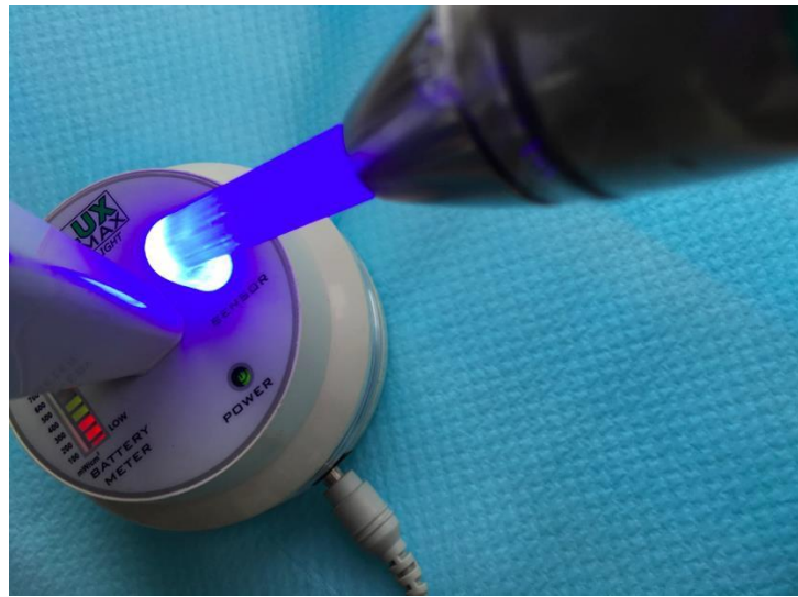
Şekil 3-12: Işık cihazının gücünün kontrol edilmesi
