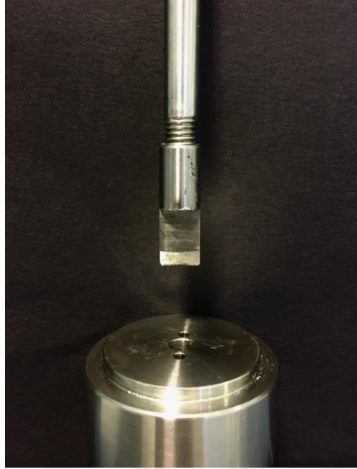
Şekil 3-30: Evrensel test cihazının yükleme ucu ve örneğin yerleştirildiği alt tablası
