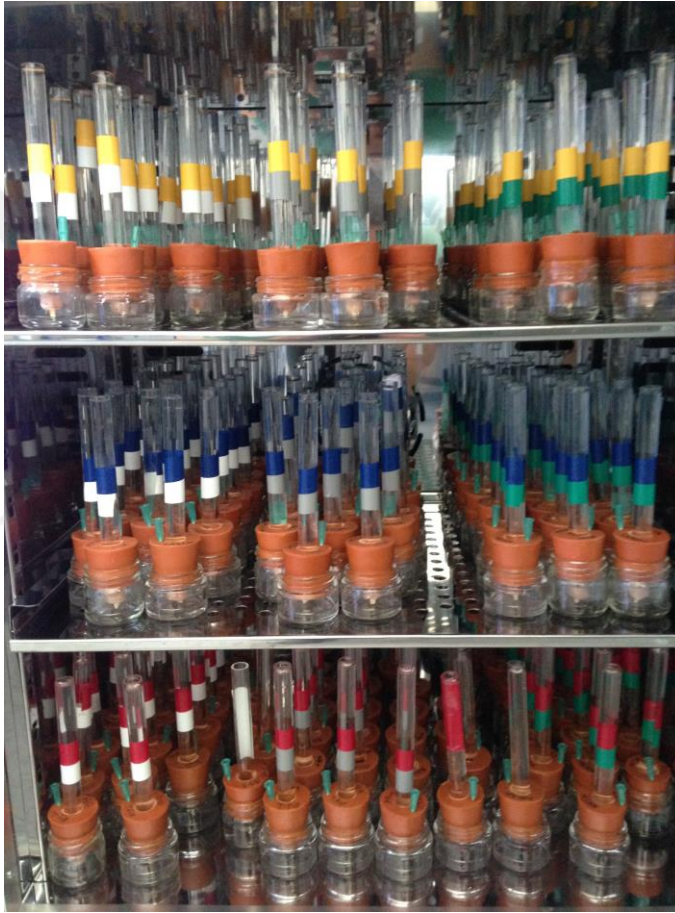
Şekil 3-16: Mikrosızıntı test düzeneği
