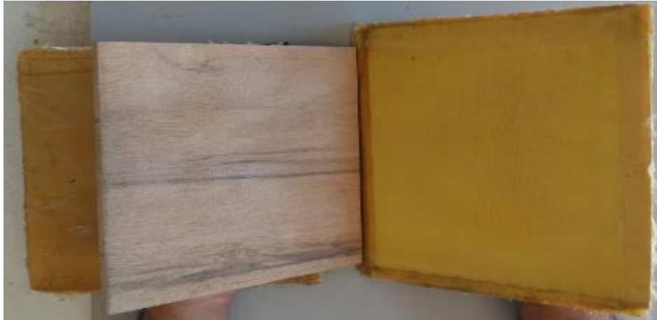
Şekil 5.18. 11.Numune Kontrplak-Aramid fiber ara yüzeyinin atış sonrası görünümü
