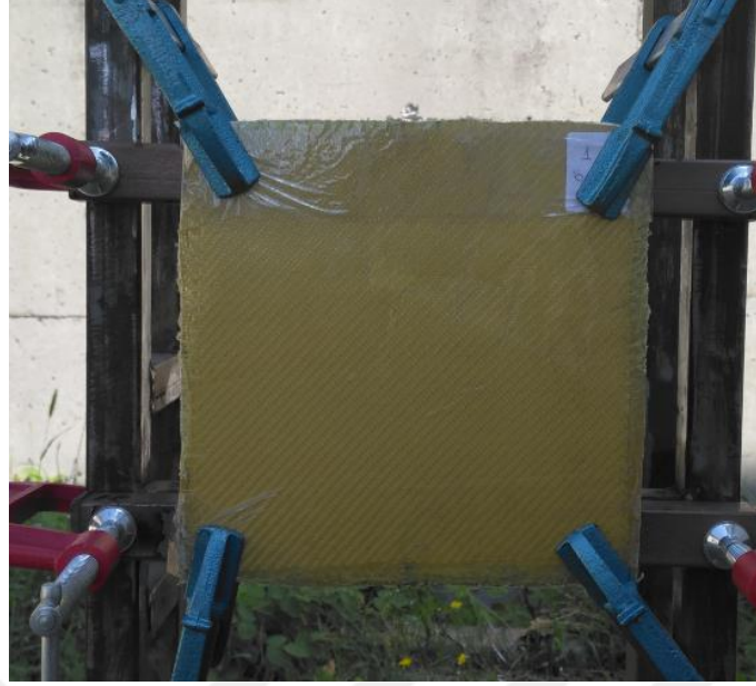
Şekil 4.26. 10.Numune Kevlar-Kontrplak-Cam fiber-Kontrplak-Karbon fiber kombinasyonu
