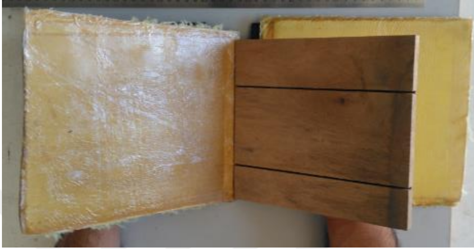
Şekil 5.17. 11.Numune Aramid fiber-Kontrplak ara yüzeyinin atış sonrası görünümü
