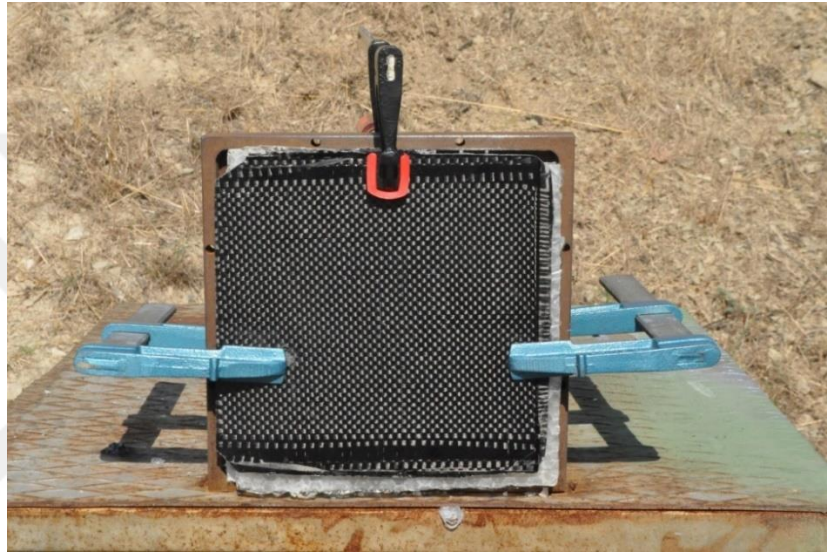
Şekil 4.25. 9.Numune Karbon fiber-Polipropilen peteği-Polipropilen peteği-Çelik elek teli kombinasyonu
