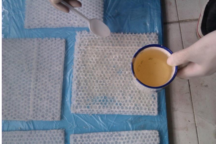
Şekil 4.14. Polipropilen peteğinin epoksi reçineyle doldurulması
