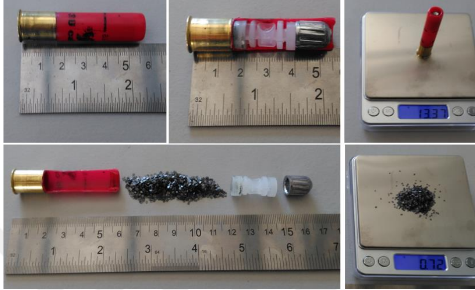
Şekil 4.2.Yavaşçalar marka, YAF Slug 36 kalibre fişek
