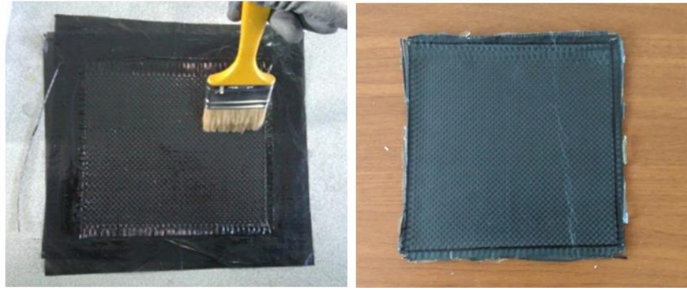
Şekil 4.6. Karbon fiber üzerine epoksi uygulanması
