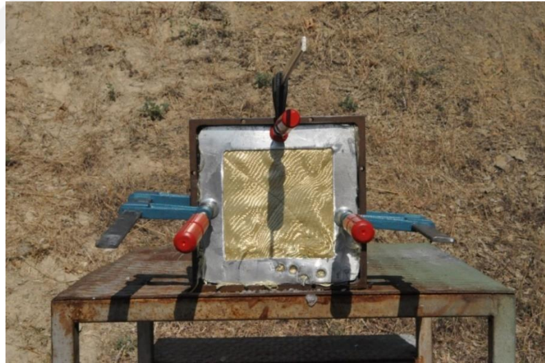
Şekil 4.18. 2.Numune Kevlar-Karbon fiber kombinasyonu
