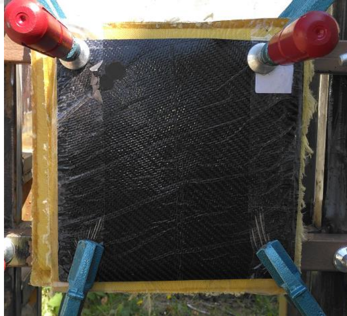
Şekil 4.27. 11.Numune Kabon fiber-Aramid fiber-Kontrplak- Aramid fiber-Kabon fiber kombinasyonu
