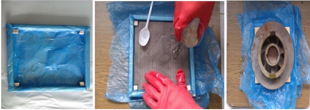
Şekil 4.12. Çelik elek teli-Epoksi reçine kompozitinin hazırlanma aşamaları
