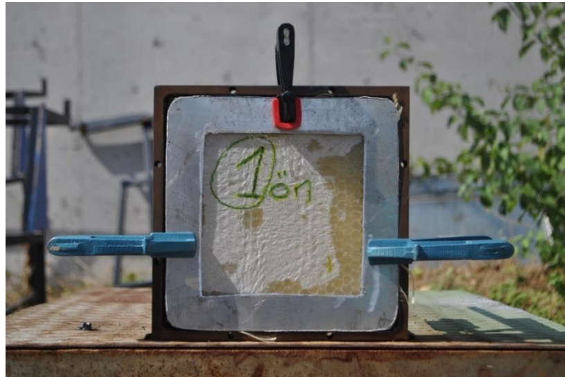
Şekil 4.20. 4. Numune Polipropilen peteği-Kevlar kombinasyonu
