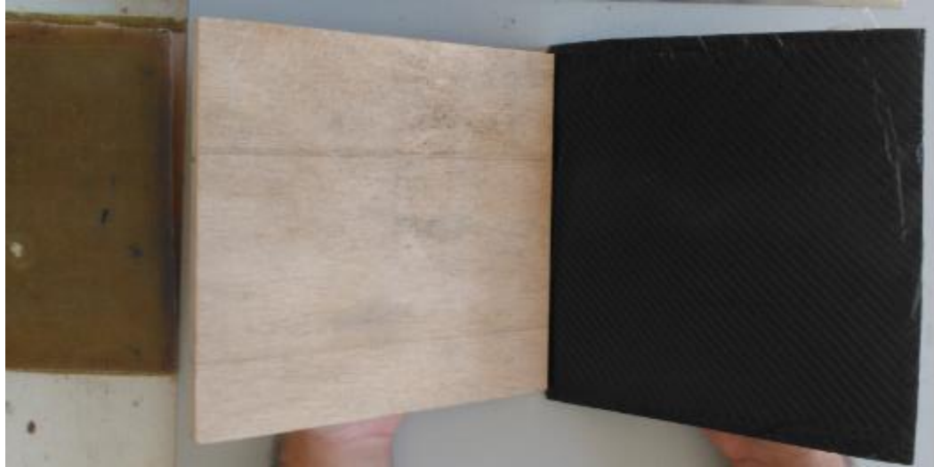
Şekil 5.14. 10.Numune Kontrplak-Karbon fiber ara yüzeyinin atış sonrası görünümü
