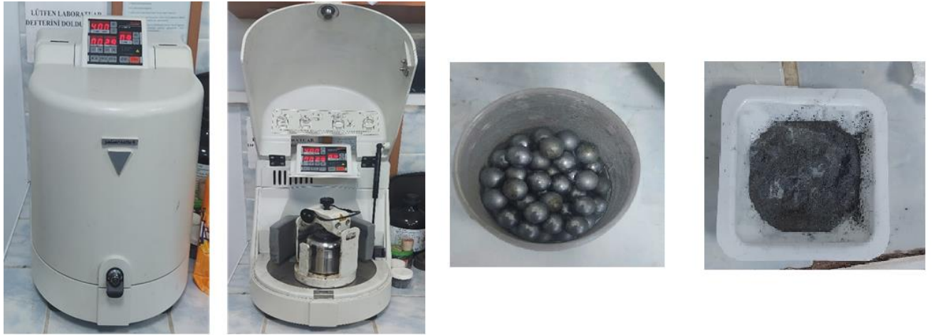
Şekil 3.5: Pulverisette-6 MA Cihazı, WC bilyeler ve metalik tozlar
