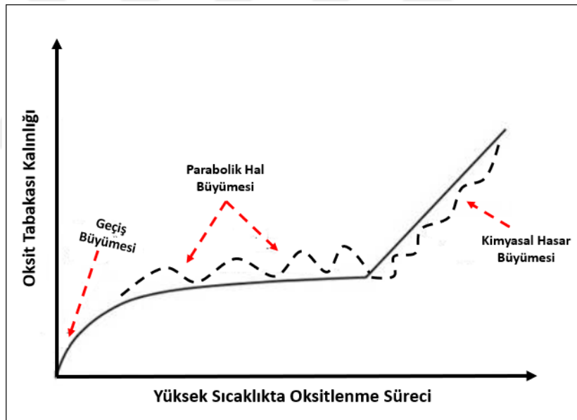
řekil 4.39:TGO tabakasının büyüyüp ilerlemesinde doğrudan etkili olan üç ařamanın kalınlık-zaman grafięi (Karaoglanlı, 2017).
