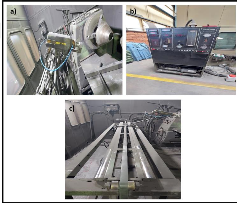
Şekil 3.4: HVOF kaplama yöntemine ait gerçek cihaz görünümü; (a) kaplama tabancası, (b) toz besleme ve gaz ünitesi, (c) tabanca hareket kızıağı
