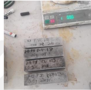
Şekil EK B.4. 100 Çevrim D-Ç etkisinde hazır G1 %1 grout numuneleri
