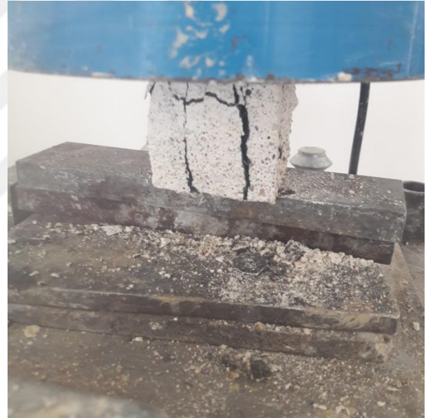
Şekil 3.26. Asit ortamları öncesi ve sonralarında bazı grout harçların basınç dayanımı testi
