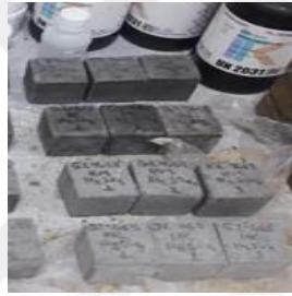
Şekil EK A23. H_2SO_4 asit ortamı öncesi ve sonrası tasarlanmış G1 %1,5 grout küp numuneleri
