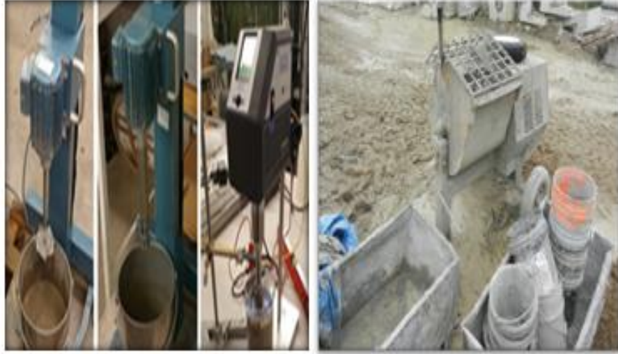
Şekil 2.1. Grout harçların laboratuvar ve saha ortamında karıştırılması [23]
