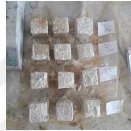
Şekil EK A10. H_2SO_4 asit ortamı öncesi ve sonrası hazır G1 %1 grout küp numuneleri
