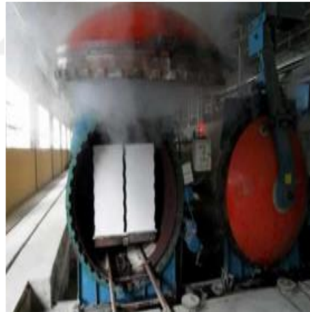
Şekil 2.11. Buhar kürü uygulaması [47]
