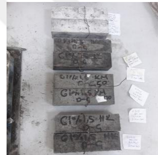
Şekil EK B.4. 100 Çevrim D-Ç etkisinde hazır G1 %1 grout numuneleri
