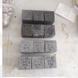
Şekil EK A2. HCl asit ortamı öncesi ve sonrası hazır G1 %1 grout küp numuneleri
