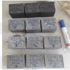
Şekil EK A10. H_2SO_4 asit ortamı öncesi ve sonrası hazır G1 %1 grout küp numuneleri
