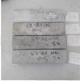
Şekil EK B.11. 50 Çevrim D-Ç etkisinde tasarlanmış G2 %1 grout numuneleri
