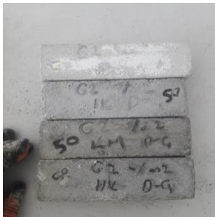
Şekil EK B.15. 50 Çevrim D-Ç etkisinde tasarlanmış G2 %2 grout numuneleri
