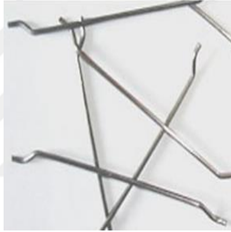
Şekil 2.14. Tipik kancalı uçlu çelik lif [60]
