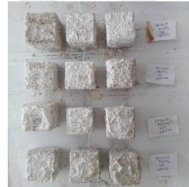
Şekil EK A11. H_2SO_4 asit ortamı öncesi ve sonrası hazır G1 %1,5 grout küp numuneleri
