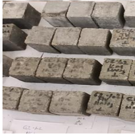
Şekil EK A15. HCl asit ortamı öncesi ve sonrası tasarlanmış G2 %1,5 grout küp numuneleri
