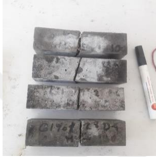
Şekil EK B.3. 50 Çevrim D-Ç etkisinde hazır G1 %1 grout numuneleri
