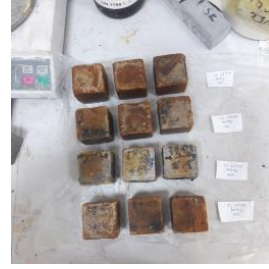
Şekil EK A5. \text{HNO}_3 asit ortamı öncesi ve sonrası hazır G1 grout küp numuneleri
