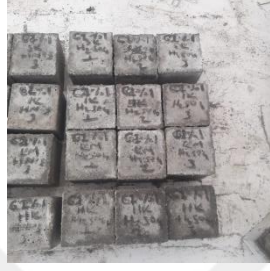
Şekil EK A18. HNO 3 asit ortamı öncesi ve sonrası tasarlanmış G2%1 grout küp numuneleri
