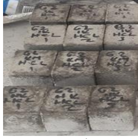
Şekil EK A13. HCl asit ortamı öncesi ve sonrası tasarlanmış G2 grout küp numuneleri
