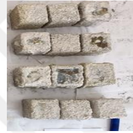
Şekil EK A23. H_2SO_4 asit ortamı öncesi ve sonrası tasarlanmış G1 %1,5 grout küp numuneleri
