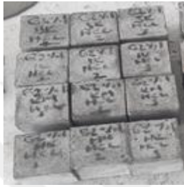
Şekil EK A14. HCl asit ortamı öncesi ve sonrası tasarlanmış G2 %1 grout küp numuneleri
