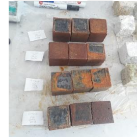
Şekil EK A7. \text{HNO}_3 asit ortamı öncesi ve sonrası hazır G1 %1,5 grout küp numuneleri
