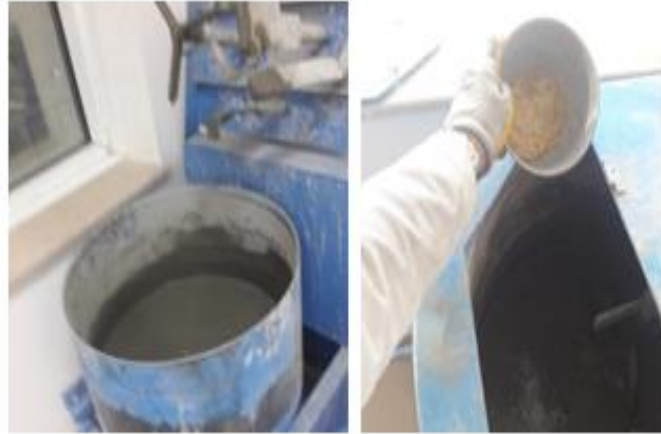
Şekil 3.13. Grout harcın karıştırılması ve mikro çelik lif eklenmesi
