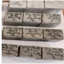
Şekil EK A24. H_2SO_4 asit ortamı öncesi ve sonrası tasarlanmış G2 %2 grout küp numuneleri
