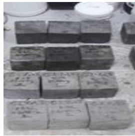
Şekil EK A20. G1 %2 HNO 3 asit öncesi ve asit sonrası tasarlanmış G2 %2 küp numuneler
