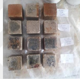
Şekil EK A2. HCl asit ortamı öncesi ve sonrası hazır G1 %1 grout küp numuneleri
