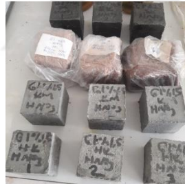
Şekil EK A7. \text{HNO}_3 asit ortamı öncesi ve sonrası hazır G1 %1,5 grout küp numuneleri
