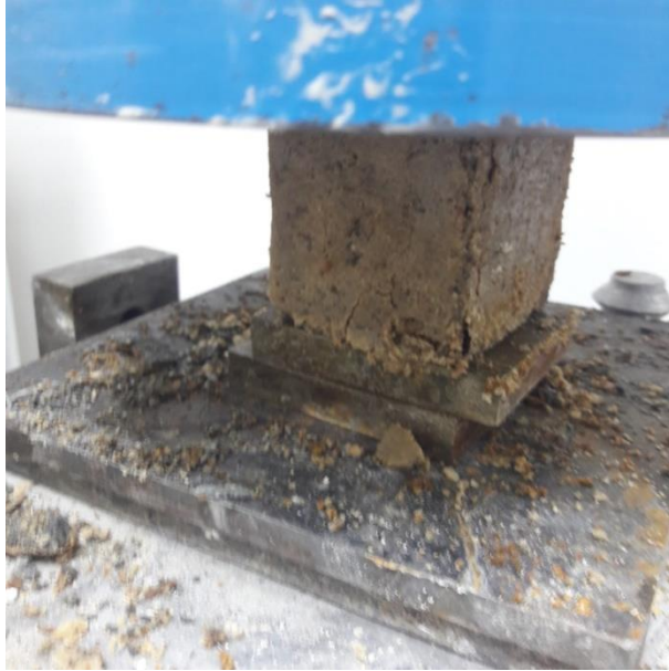
Şekil 3.26. Asit ortamları öncesi ve sonralarında bazı grout harçların basınç dayanımı testi
