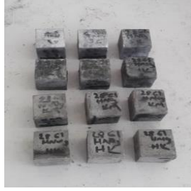
Şekil EK A5. \text{HNO}_3 asit ortamı öncesi ve sonrası hazır G1 grout küp numuneleri
