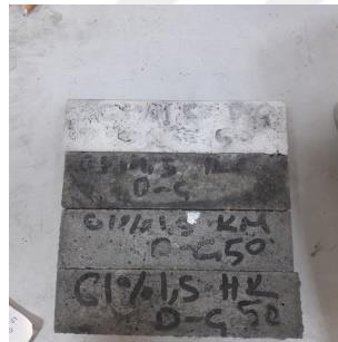
Şekil EK B.3. 50 Çevrim D-Ç etkisinde hazır G1 %1 grout numuneleri
