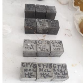
Şekil EK A3. HCl asit ortamı öncesi ve sonrası hazır G1 %1,5 grout küp numuneleri
