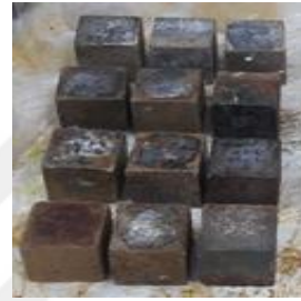
Şekil EK A14. HCl asit ortamı öncesi ve sonrası tasarlanmış G2 %1 grout küp numuneleri
