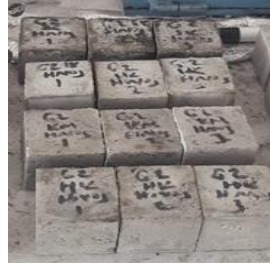
Şekil EK A17. G1 HNO 3 asit öncesi ve asit sonrası tasarlanmış G2 grout küp numuneleri
