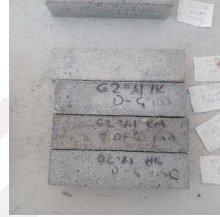
Şekil EK B.12. 100 Çevrim D-Ç etkisinde tasarlanmış G2 %1 grout numuneleri
