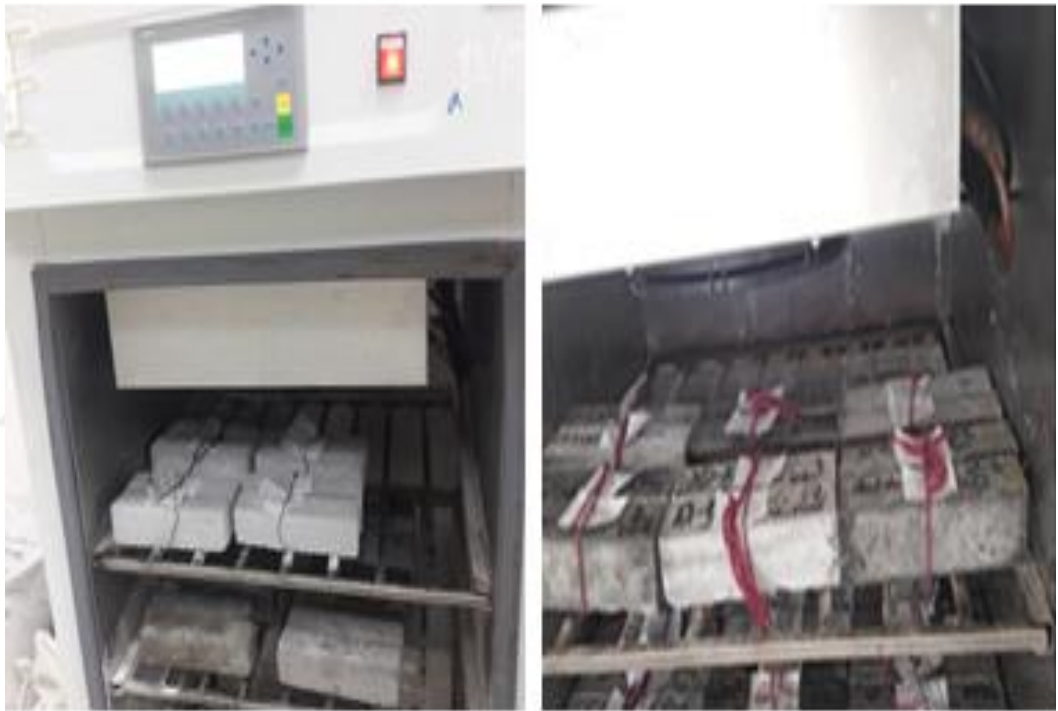
Şekil 3.27. İklimlendirme kabini ve D-Ç deneyine tabi tutulan grout numuneleri
