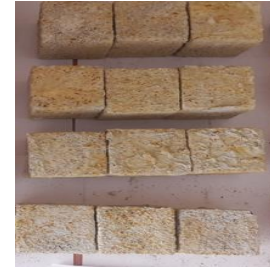
Şekil EK A12. H_2SO_4 asit ortamı öncesi ve sonrası hazır G1 %2 grout küp numuneleri
