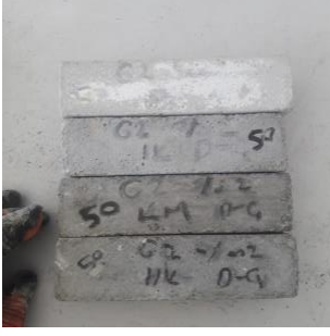
Şekil EK B.9. 50 Çevrim D-Ç etkisinde tasarlanmış G2 grout numuneleri
