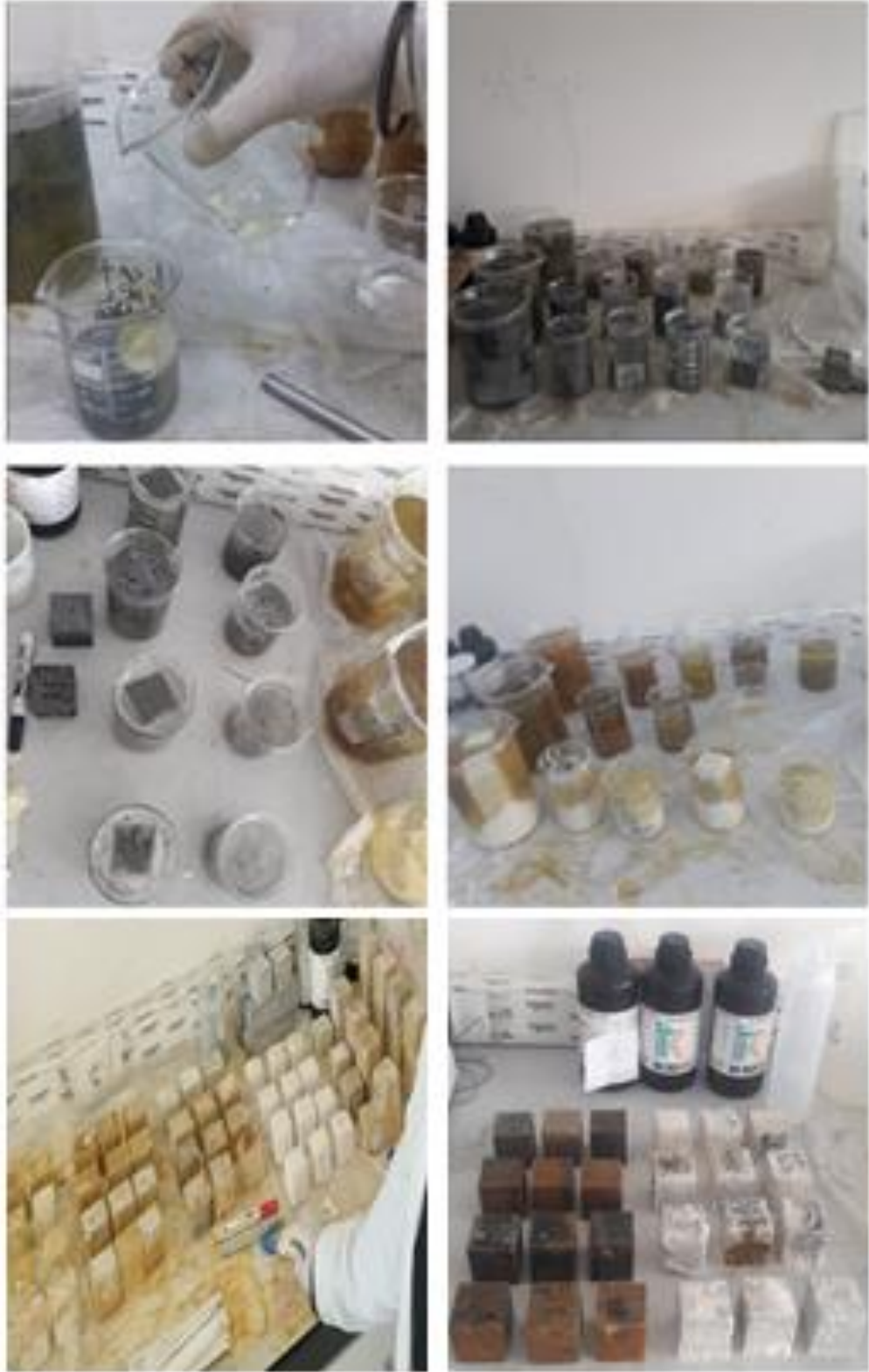
Şekil 3.25 Asit direncin belirlenmesi için yapılan deneyler ve asit ortamı sonrası numune görsellerine ait bazı fotolar
