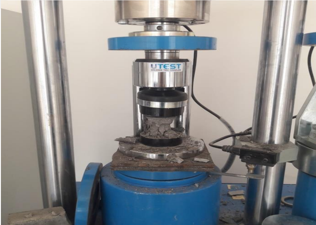
Şekil 3.24. 5 cm küp ayrıtlı grout numunesinin basınç dayanım deneyi
