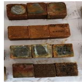
Şekil EK A20. G1 %2 HNO 3 asit öncesi ve asit sonrası tasarlanmış G2 %2 küp numuneler
