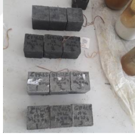
Şekil EK A11. H_2SO_4 asit ortamı öncesi ve sonrası hazır G1 %1,5 grout küp numuneleri
