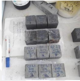
Şekil EK A6. \text{HNO}_3 asit ortamı öncesi ve sonrası hazır G1 %1 grout küp numuneleri
