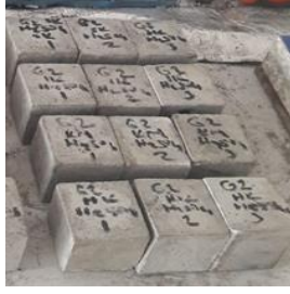
Şekil EK A21. H_2SO_4 asit ortamı öncesi ve sonrası tasarlanmış G2 grout küp numuneleri
