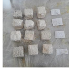
Şekil EK A9. H_2SO_4 asit ortamı öncesi ve sonrası hazır G1 grout küp numuneleri
