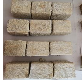
Şekil EK A24. H_2SO_4 asit ortamı öncesi ve sonrası tasarlanmış G2 %2 grout küp numuneleri
