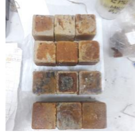
Şekil EK A1. HCl asit ortamı öncesi ve sonrası hazır G1 grout küp numuneleri
