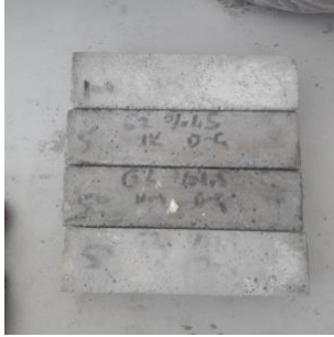
Şekil EK B.13. 50 Çevrim D-Ç etkisinde tasarlanmış G2 %1,5 grout numuneleri
