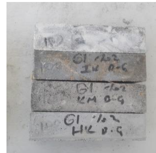
Şekil EK B.8. 100 Çevrim D-Ç etkisinde hazır G1 %2 grout numuneleri
