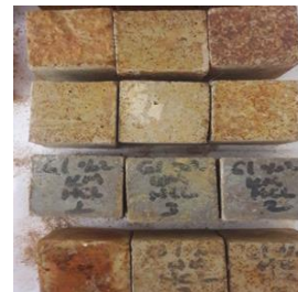
Şekil EK A4. HCl asit ortamı öncesi ve sonrası hazır G1 %2 grout küp numuneleri
