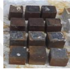
Şekil EK A19. HNO 3 asit ortamı öncesi ve sonrası tasarlanmış G2 %1,5 grout küp numuneleri
