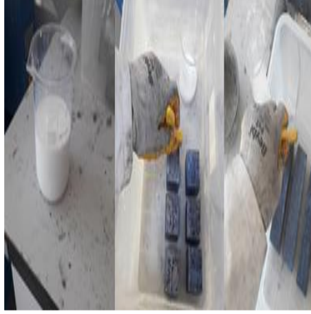
Şekil 3.9. Kür malzemesi uygulaması
