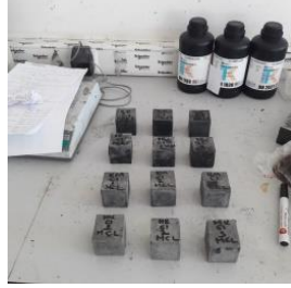
Şekil EK A1. HCl asit ortamı öncesi ve sonrası hazır G1 grout küp numuneleri
