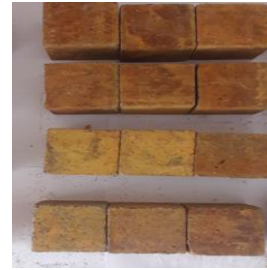
Şekil EK A16. HCl asit ortamı öncesi ve sonrası tasarlanmış G2 %2 grout küp numuneleri
