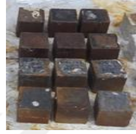
Şekil EK A18. HNO 3 asit ortamı öncesi ve sonrası tasarlanmış G2%1 grout küp numuneleri
