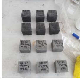
Şekil EK A9. H_2SO_4 asit ortamı öncesi ve sonrası hazır G1 grout küp numuneleri
