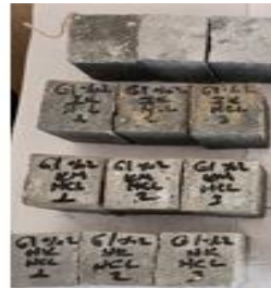
Şekil EK A4. HCl asit ortamı öncesi ve sonrası hazır G1 %2 grout küp numuneleri
