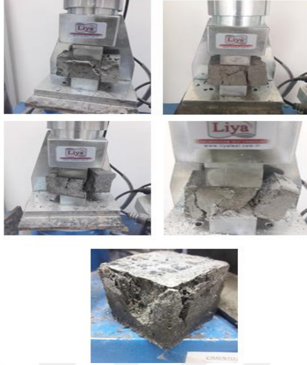
Şekil 4.11. Eğilme sonrası ikiye ayrılan prizma grout numunelerine ve küp numunelere uygulanan basınç dayanımı davranışına ait bazı görseller
