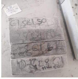
Şekil EK B.1. 50 Çevrim D-Ç etkisinde hazır G1 grout numuneleri
