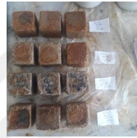
Şekil EK A6. \text{HNO}_3 asit ortamı öncesi ve sonrası hazır G1 %1 grout küp numuneleri
