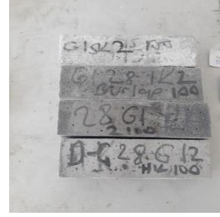
Şekil EK B.2. 100 Çevrim D-Ç etkisinde hazır G1 grout numuneleri
