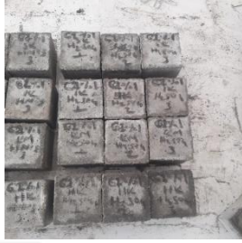
Şekil EK A22. H_2SO_4 asit ortamı öncesi ve sonrası tasarlanmış G2 %1 grout küp numuneleri
