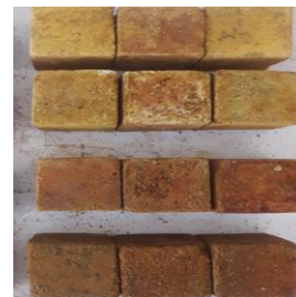
Şekil EK A8. Şekil A6. \text{HNO}_3 asit ortamı öncesi ve sonrası hazır G1 %2grout küp numuneleri
