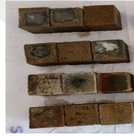
Şekil EK A15. HCl asit ortamı öncesi ve sonrası tasarlanmış G2 %1,5 grout küp numuneleri
