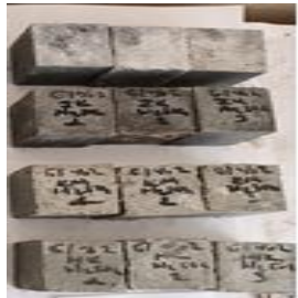
Şekil EK A12. H_2SO_4 asit ortamı öncesi ve sonrası hazır G1 %2 grout küp numuneleri
