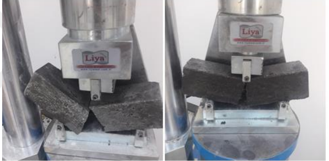
Şekil 4.6. a) Çelik lif katkısız numunenin eğilme davranışı b) Mikro çelik lif katkılı numunenin eğilme davranışı
