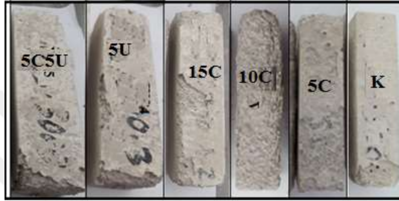
Şekil 4.53GP numunelerinde 150 donma-çözülme çevrimindeki fiziksel hasar
