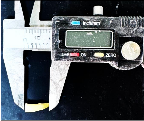
Şekil 3.1. Dişlerin boyunun 16 mm'ye kumpas yardımıyla ayarlanması
