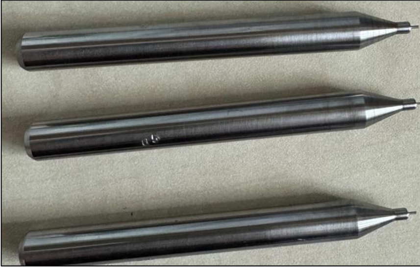
Şekil 3.18. Sırasıyla apikal, orta ve koronal bölüme karşılık gelen 3 farklı çapta (0.5-0.6-0.7) paslanmaz çelik silindirik pistonlar
