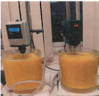
Şekil 3.1. Çift cidarlı ısıtmalı reaktörde pektin ekstraksiyonu
