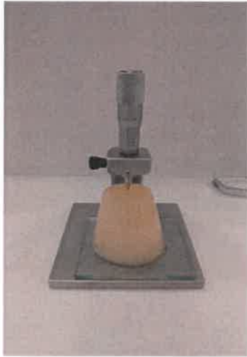
Şekil 3.8. Ridgelimetre cihazında SAG değeri ölçümü
