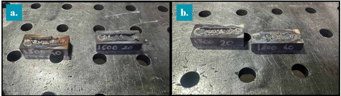
Şekil 5.5: 1500 W lazer gücünde a) 20 Hz ve b) 40 Hz salınım frekansı ile kaplanmış numuneler.
