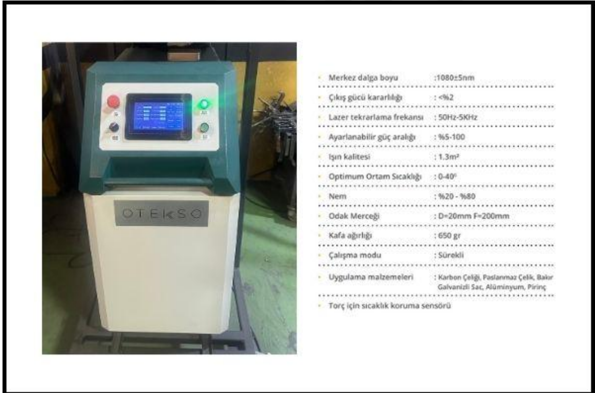
Şekil 5.2: Kullanılan kaynak makinasının resmi ve teknik özellikleri.
