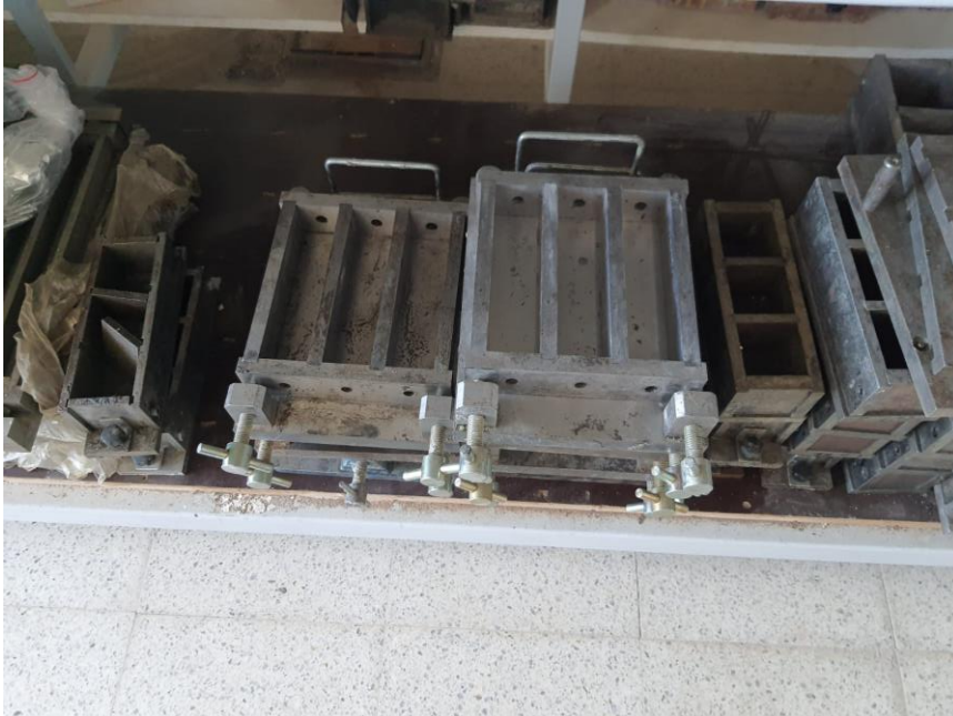
Şekil 3.2.3. Beton dökme kalıpları.
