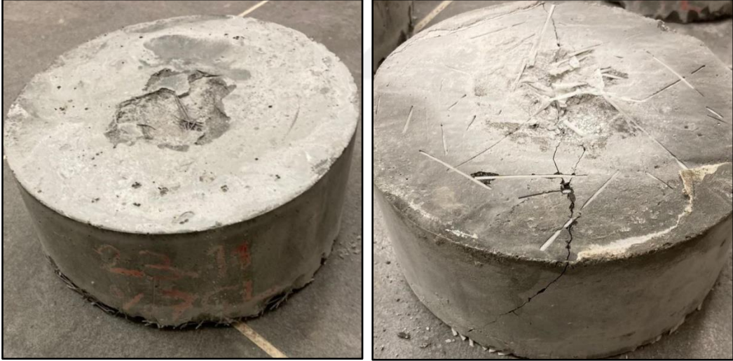
Şekil 3.21. Ağırlık düşürme deneyi uygulanan %7 çelik lifli ve %7 polipropilen lifli numuneler
