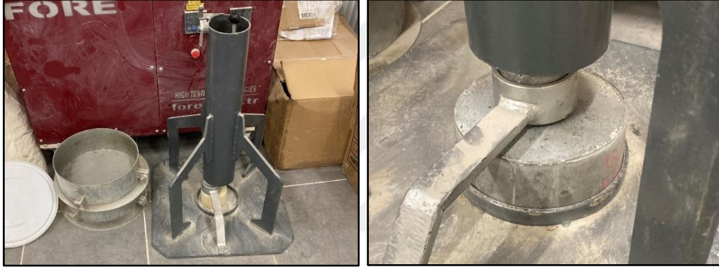
Şekil 3.19. Ağırlık düşürme deney düzeneği ve numune üzerinde uygulaması
